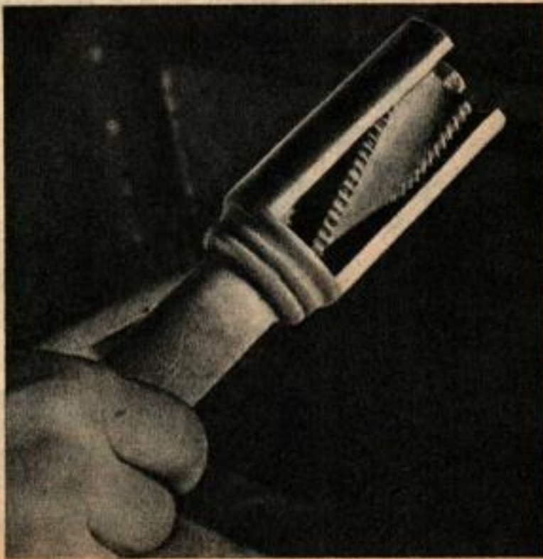
En écaillant le poisson au moyen du couteau rotatif que l'on voit à droite, l'ouvrier envoie dans l'outil un jet d'eau sous pression.
