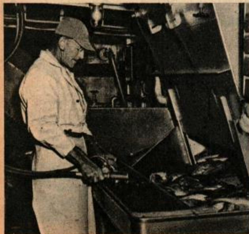
En écaillant le poisson au moyen du couteau rotatif que l'on voit à droite, l'ouvrier envoie dans l'outil un jet d'eau sous pression.
