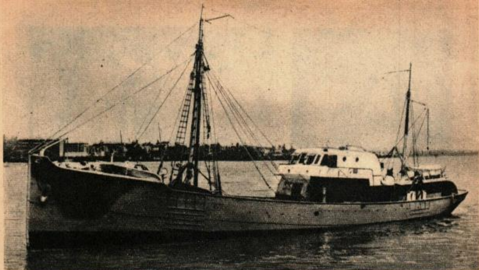
Sous le pont de l'Oceanlife, bateau de pêche long de 45 m, se dissimule une usine de nettoyage et de congélation du poisson.
