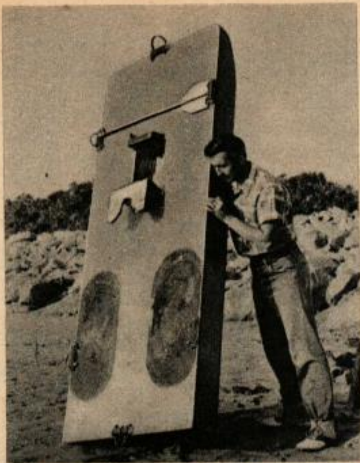
Une pagaie de secours est fixée à l'aquaplane. La plate-forme est conçue de manière à ce que l'eau n'éclabousse pas le pilote.
