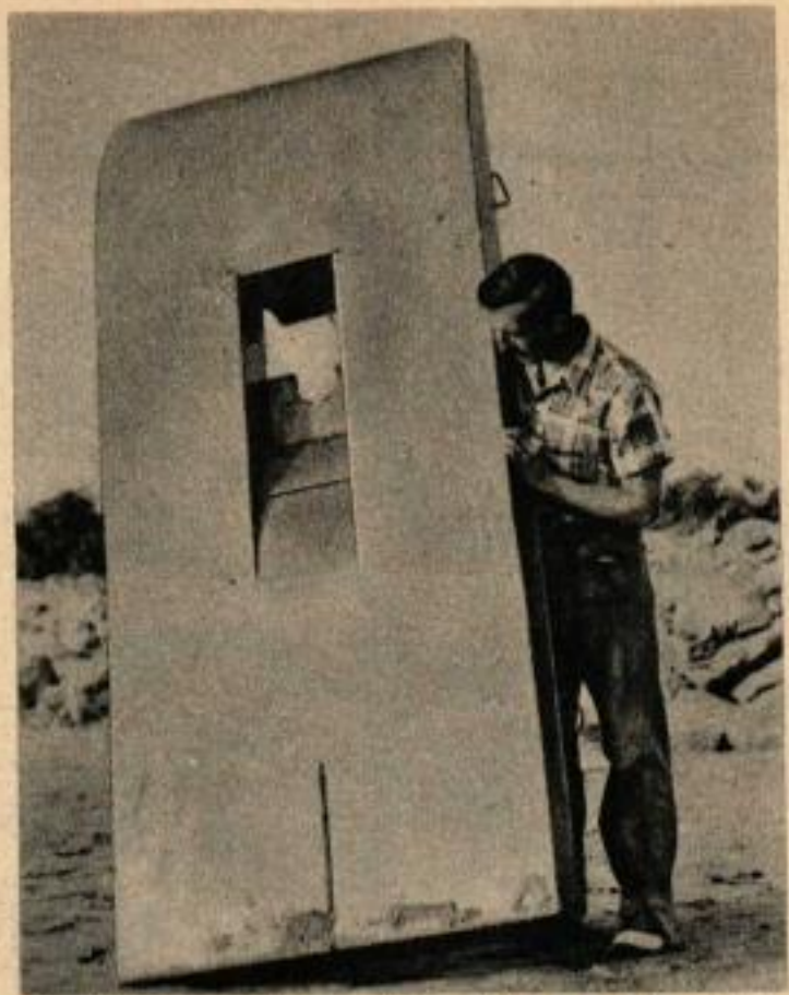
La plate-forme pèse seulement 30 kg sans le moteur. Le fond de la «coque» est muni d'une fente pour le moteur et d'un gouvernail escamotable.
