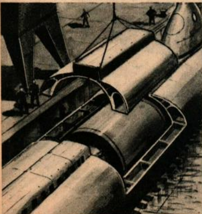
UNE PARTIE DE LA COQUE PEUT ETRE ENLEVEE POUR DECOUVRIR LE REACTEUR
