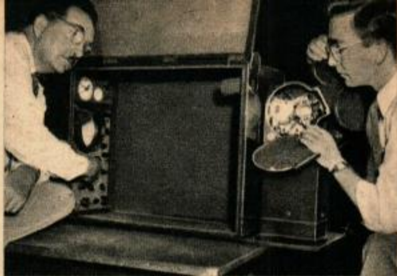
L'appareil photographie automatiquement les éclairs qui s'inscrivent en ondulations sur l'écran de l'oscilloscope.
