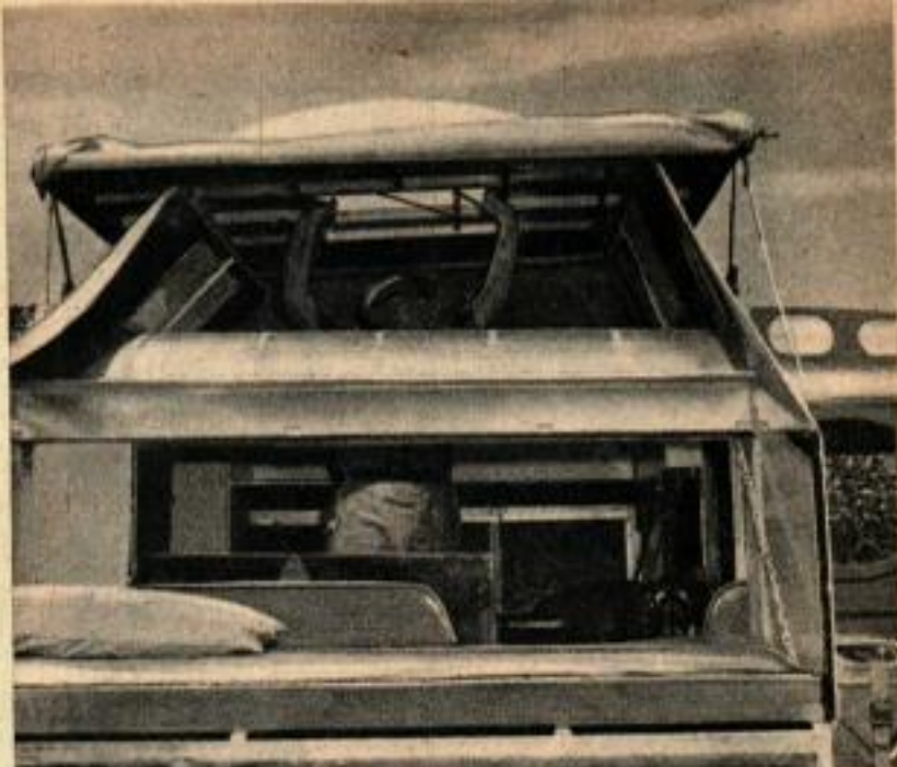
L'une des parois en toile est roulée pour montrer comment on peut lever doucement la toiture et les extrémités en même temps.
