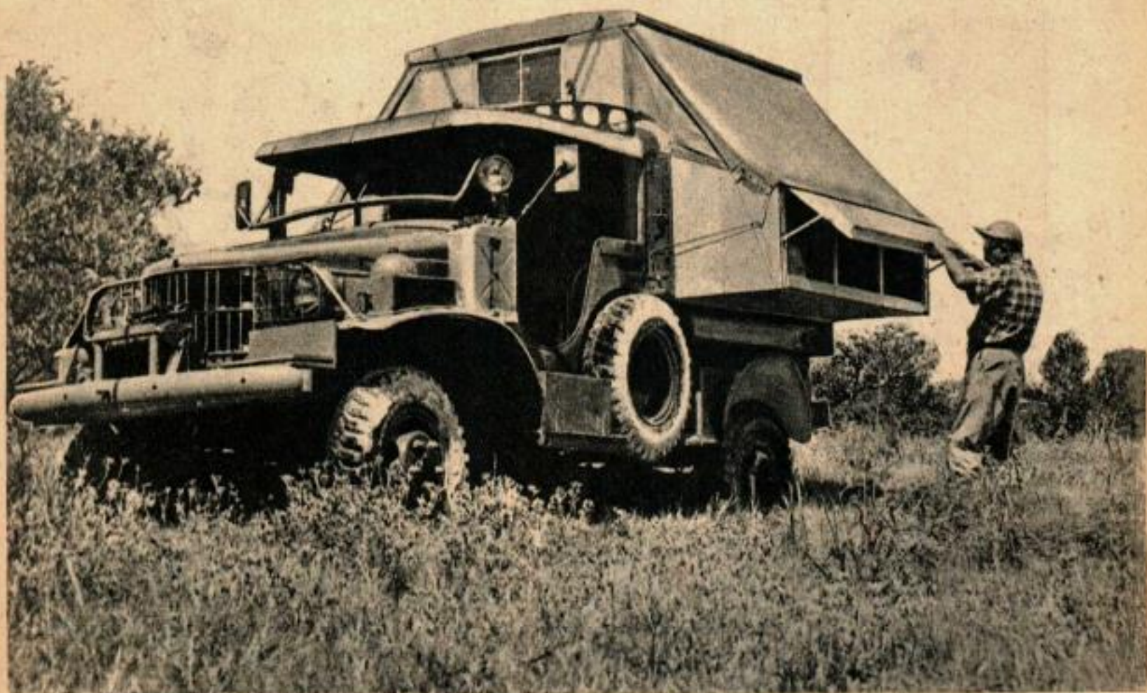
La carrosserie se déplie pour donner plus d'espace; des auvents en contreplaqué, protégeant les couchettes, sont relevés quand il fait chaud, ainsi que les fenêtres supérieures.
