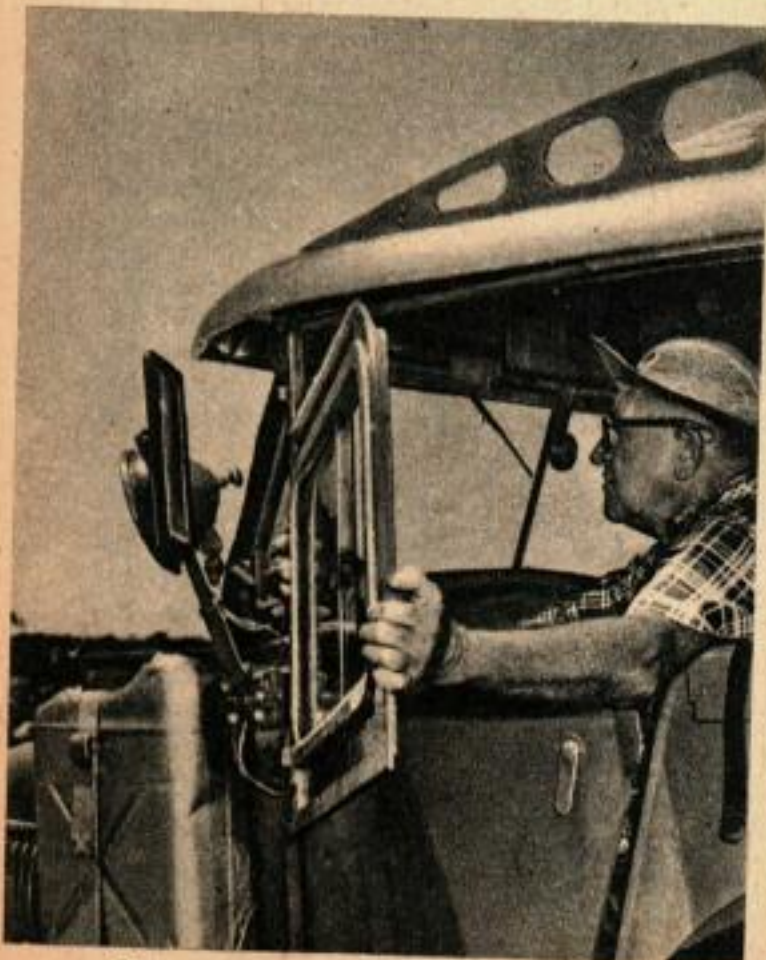
Le nouveau treuil, manœuvré par un embrayage ordinaire, peut aussi être actionné à la main. Il remplace un treuil électrique. Ci-dessous: une nervure d'avion maintient le dessus de la cabine.
