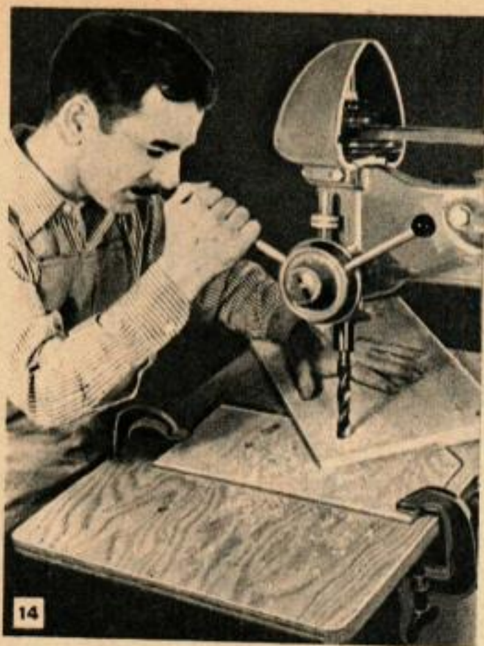
Les angles composés égaux peuvent être convertis en angles simples au moyen du tableau figurant en haut de la page. Notez que la ligne de perçage fait toujours un angle de 45^\circ avec les bords de la surface de la pièce.
