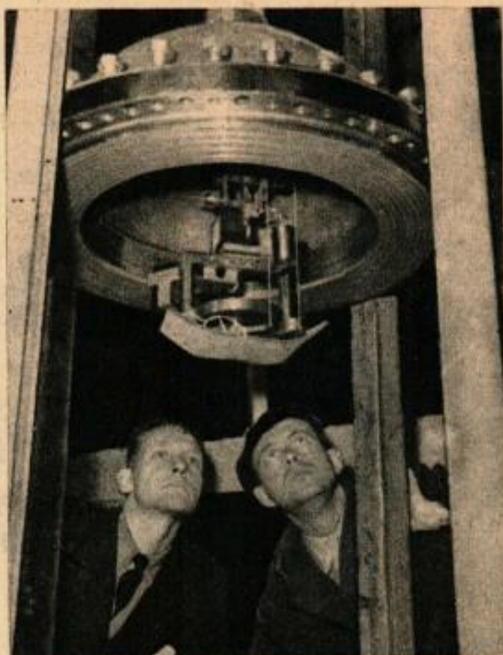
La sphère de bronze contient des instruments destinés à mesurer le magnétisme terrestre, afin de déterminer s'il s'accroît avec la profondeur.
