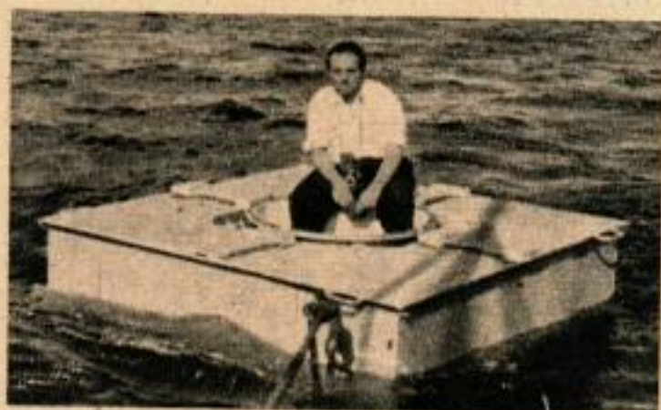
Quand un monstre des profondeurs est ramené le long de la coque, un photographe peut descendre dans la mer au moyen d'un caisson flottant muni d'un hublot de prise de vue en verre épais.
