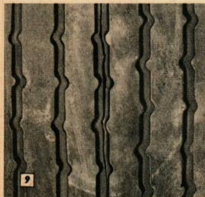
9 Un gonflage toujours excessif donne des ruptures du genre ci-dessus. Il est très dangereux de conduire une voiture munie de tels pneus surtout si la route est encombrée.
