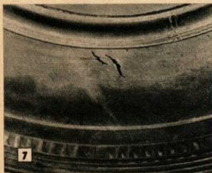
7 Dans les vieux pneus, les fissures se produisent aussi sur l'extérieur de l'enveloppe. Un pli excessif entraîne un pincement de la chambre à air, qui provoque une rupture, immédiate ou différée, mais qui se produit finalement.
