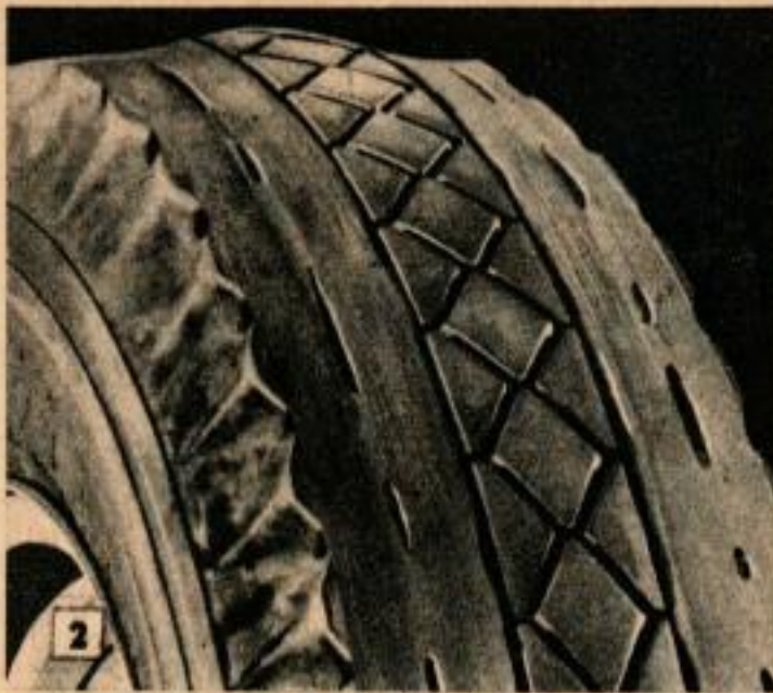
Ce type d'usure est l'indice d'une pression insuffisante. On notera l'absence d'usure au centre de la bande de roulement.
