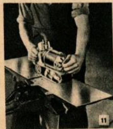
Un ruban à grains d'alumine convient très bien pour le bois ou le métal.
