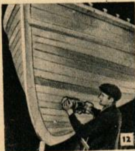
La ponceuse s'impose pour le polissage des planches de revêtement d'un bateau.
