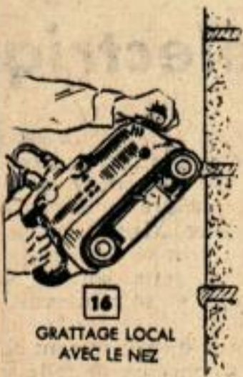
La bosse permet d'attaquer un point bien défini (joints entre des éléments).
