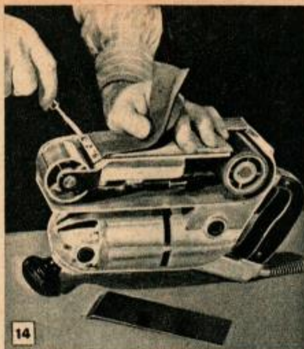
La semelle souple est utilisée sur les surfaces inégales (plâtre) ou pour la finition.
