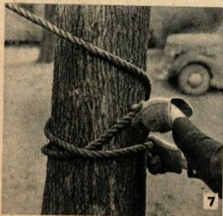
Ci-dessus, un nœud multiple au bout d'une corde permet de la lancer plus facilement par-dessus une haute branche. Ci-dessous, on emploie un nœud à clef pour bloquer la corde autour d'un tronc.
