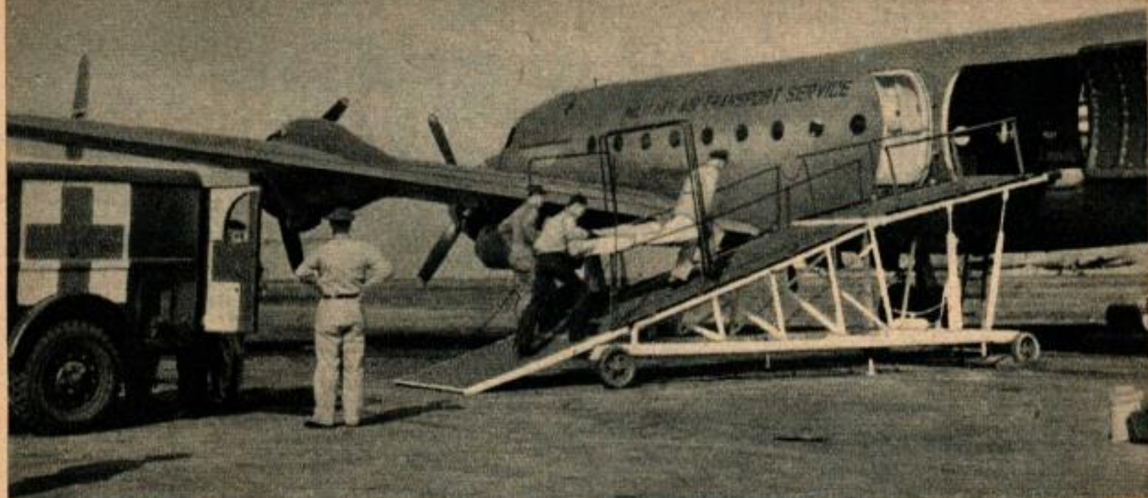
Rampe inclinée à commande hydraulique utilisée pour charger les civières à Haneda Field près de Tokio. On peut régler sa hauteur selon le type d'avion.
