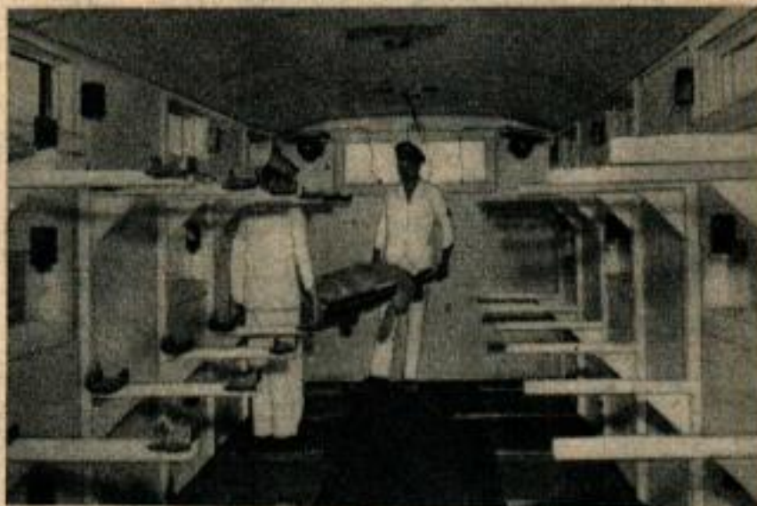
À l'intérieur de la cabine de la remorque servant d'ambulance, on voit les supports en acier fixés dans les murs de la remorque et qui servent à recevoir les brancards sur l'aérodrome de Fairfield-Suisun. Les blessés sont acheminés (ci-dessous) du terrain d'aviation à l'hôpital, immédiatement après leur débarquement.
