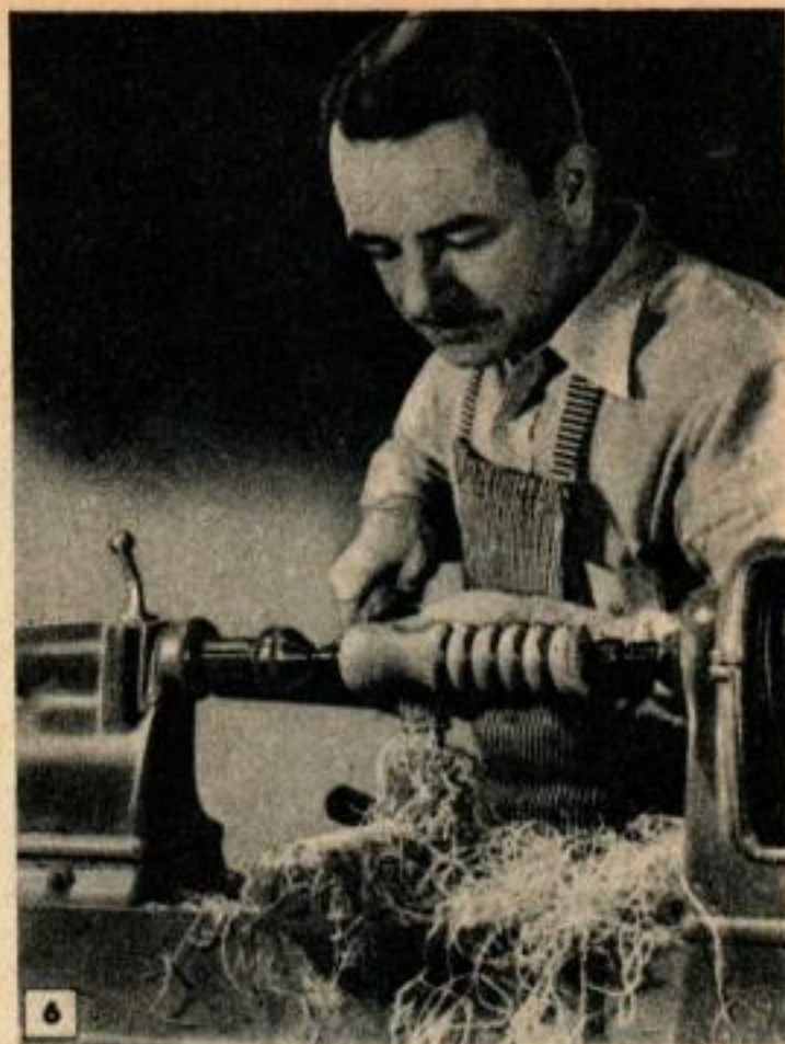
Un copeau long, mince et régulier indique que les conditions d'un bon tournage sont toutes remplies. L'incidence négative est obtenue en tenant le manche de l'outil un peu plus haut que le tranchant.
