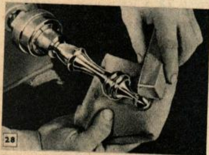
28 Ci-dessus, obtention d'un beau poli au moyen d'une pâte à polir. Ci-dessous, polissage à la laine d'acier d'une pièce composite bois-plastique.
