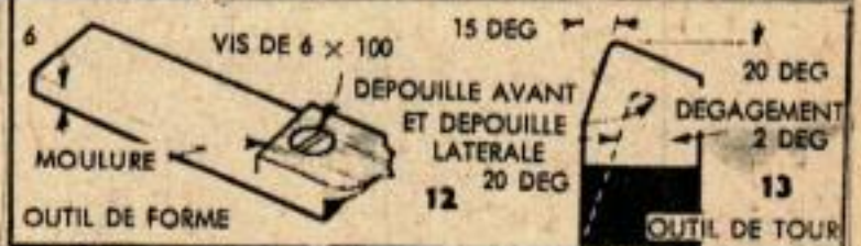
Les cordons et les hélices se font au moyen d'un outil de forme (fig. 10 et 12). Les pièces longues de plus de 10 cm sont tenues par une contrepointe à billes (fig. 10). Les pièces courtes sont serrées dans le mandrin à 3 mors.
