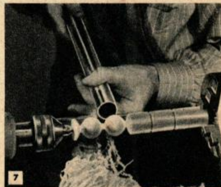
Ci-dessus et ci-dessous, tournage des sphères au moyen d'un tube à bord tranchant. Il suffit de meuler l'extrémité bien d'aplomb.
