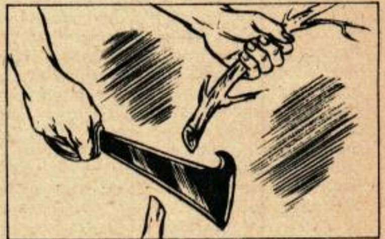
Voici deux autres exemples d'utilisation de cet outil. Pour couper les branches à la volée, utiliser la grande lame, pour débroussailler, la serpe est très pratique.
