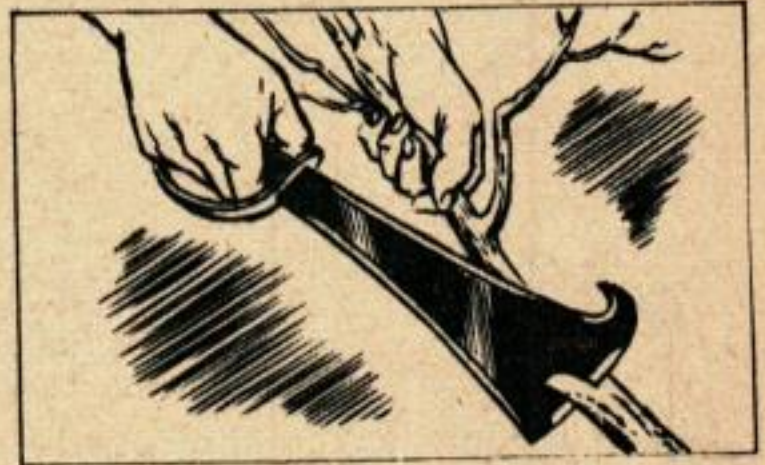
La lame en bout est très commode lorsqu'on se sert de l'outil dans des endroits où l'on manque de place.
