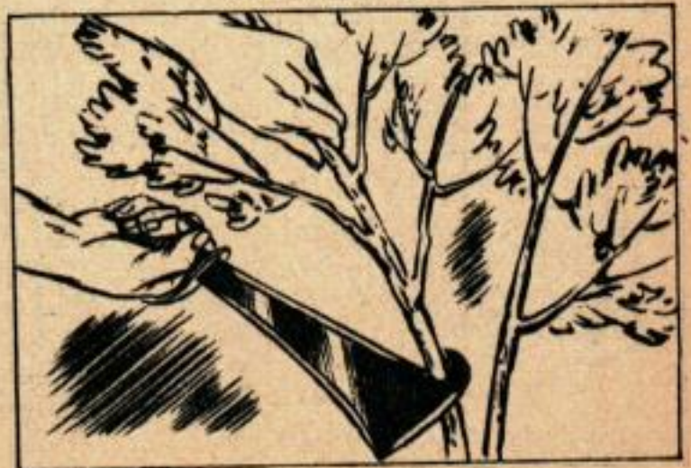
Voici deux autres exemples d'utilisation de cet outil. Pour couper les branches à la volée, utiliser la grande lame, pour débroussailler, la serpe est très pratique.
