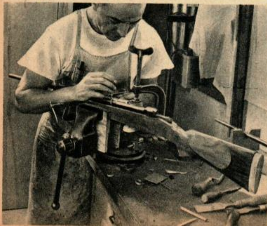
De haut en bas: la barre brute d'acier, la barre ébauchée au tour, la barre percée, alésée, rayée, usinée extérieurement, polie et enfin, la barre terminée et oxydée. Ci-dessous, pose du mécanisme de la culasse sur la crosse. A droite, gravure de la crosse.
