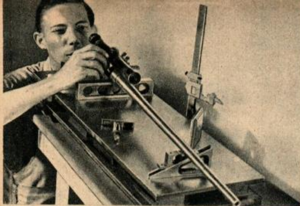
Un armurier, véritable opticien de précision, installe une lunette sur le dessus du canon. Le meilleur canon ne donne rien de bon si le réglage de la lunette est mal fait.
