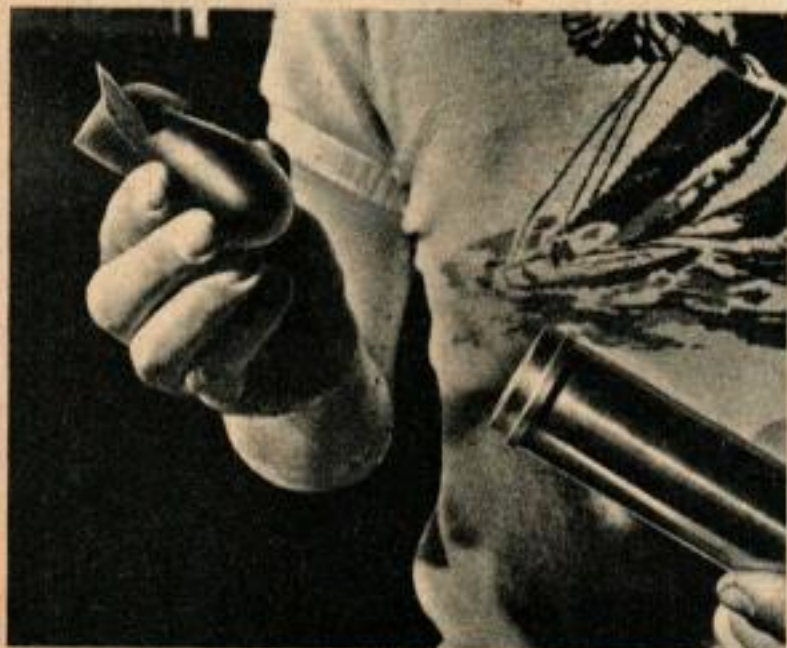
Modèle de mine qu'on place dans le cylindre servant au lancement dans l'eau. Le processus tout entier est filmé.
