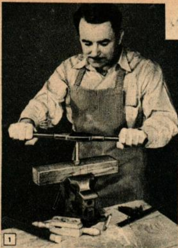
1 Ci-dessus, taraudage du trou, opération qui doit précéder le filetage du bâton rond formant vis. On obtient un bon amorçage du filet en le commençant à la perceuse.
