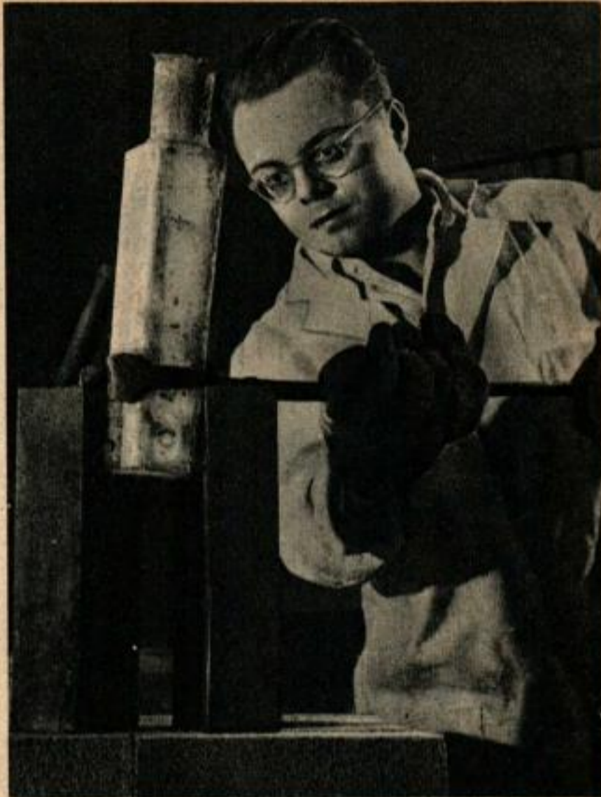
Le lingot, chauffé à blanc, est retiré du moule. De la pesée des constituants au moulage, l'opération dure à peine une heure.
