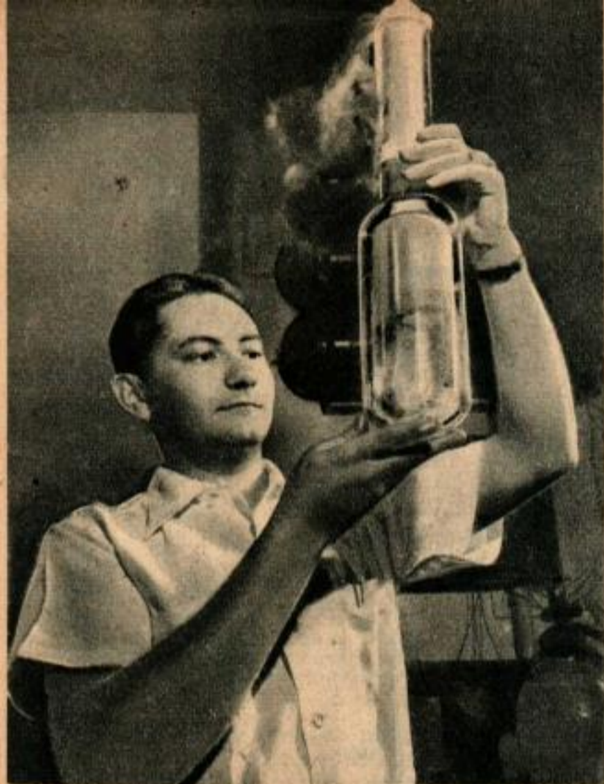
Ci-dessus, l'air liquide à -206^{\circ}\text{C} . est tellement chaud qu'il fait bouillir l'hélium liquide ( -269^{\circ}\text{C} .) lorsqu'on mélange les deux liquides. Ci-dessous, le laboratoire de la General Electric.
