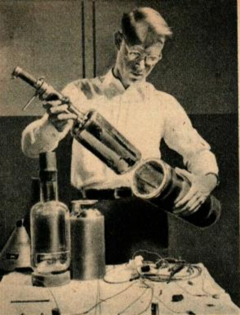
A gauche, bouteille d'hélium liquide que l'on met dans un récipient isolé thermiquement avec de l'azote liquide. L'hélium est conservé dans l'obscurité pour que la chaleur dégagée par l'absorption de la lumière ne le fasse pas bouillir. A droite, comparaison des échelles thermométriques courantes: absolue, centigrade et Fahrenheit.
