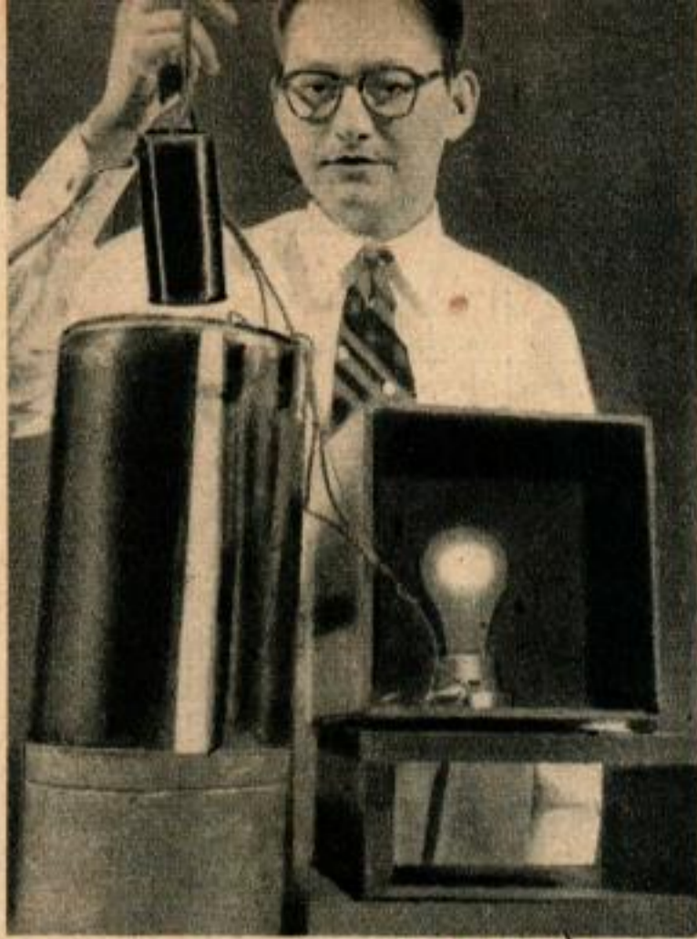
Expérience de superconductivité: A gauche, l'ampoule brille peu par suite de la forte résistance de la bobine en série avec elle. A droite, on a plongé dans de l'azote liquide la bobine en question, le refroidissement fait baisser beaucoup sa résistance et la lampe brille davantage.
