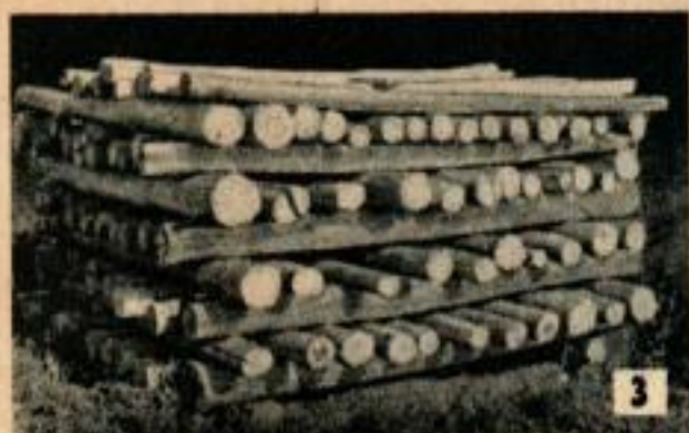
Après écorçage, les poteaux sont empilés pour le séchage avant traitement à froid.
