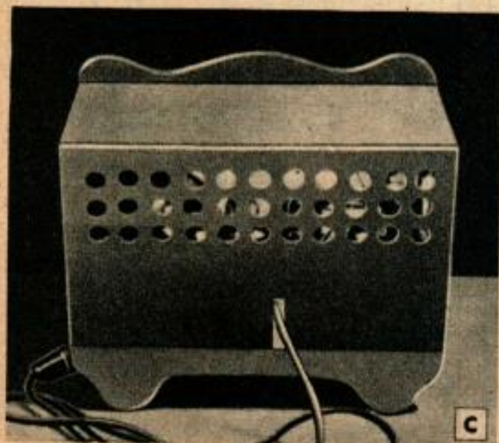
Vue montrant les trous percés dans le couvercle arrière pour permettre la ventilation nécessaire et l'ouverture pour le passage du cordon d'alimentation en 110 V.
