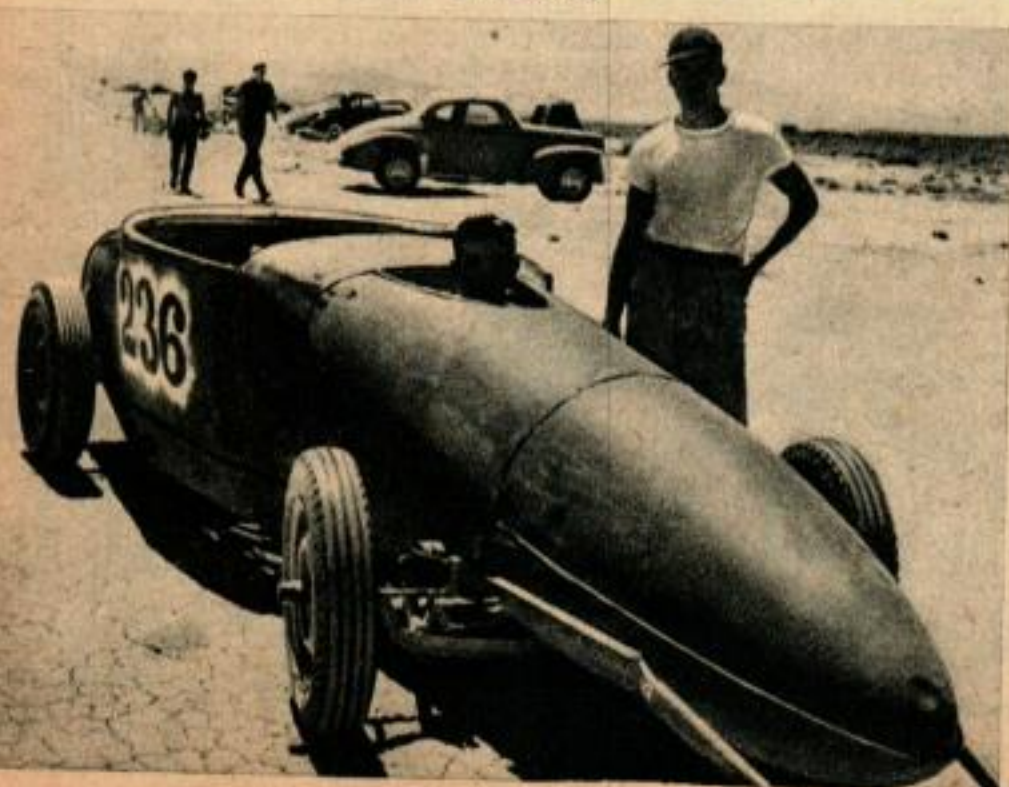
Les roadsters poussés à la limite ont 2 radiateurs mais pas de ventilateur, car ce dernier absorbe de la puissance. Ci-dessous le «tapir» ou «fourmilier», ainsi nommé à cause de la protubérance dans laquelle se logent le conducteur et ses commandes; le moteur tient toute la place à l'arrière.
