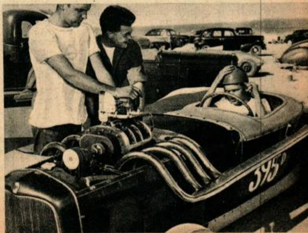
Carrosserie à toit surbaissé n'ayant qu'une bande de plexiglas comme fenêtre. Le moteur Mercury donne une vitesse de 230 km/h. Ci-dessous montage d'un compresseur construit en partie par l'amateur.
