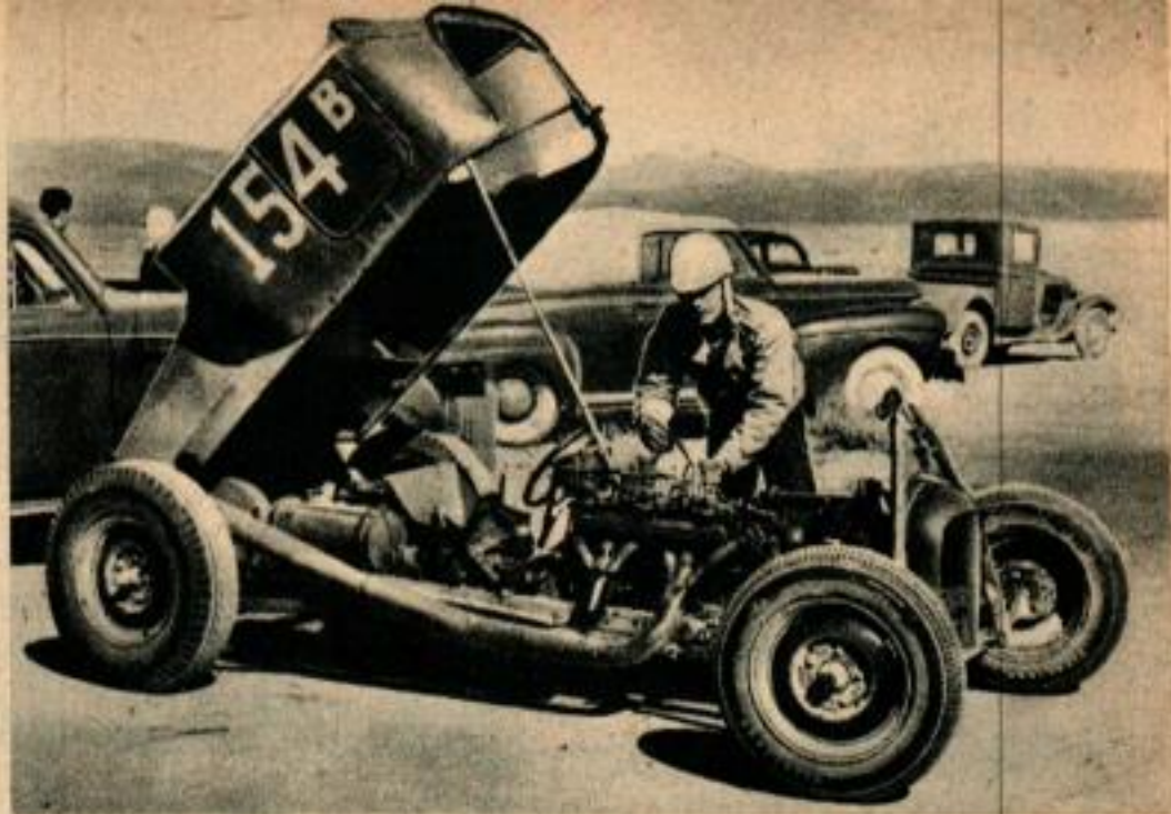
La carrosserie entière se soulève, ce qui est nécessaire pour examiner, avant la course, le moteur dont les dimensions sont trop grandes pour un capot ordinaire.
