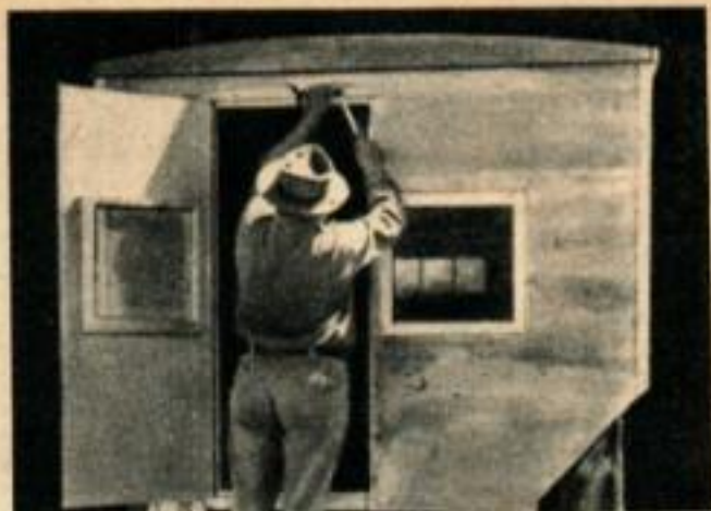
A gauche, l'extérieur du corps de la caisse est d'abord peint à l'aluminium, puis on termine par deux couches de peinture émaillée de la couleur désirée. À droite, mettre au sommet de chaque porte et fenêtre un petit linteau contre l'eau de pluie.
