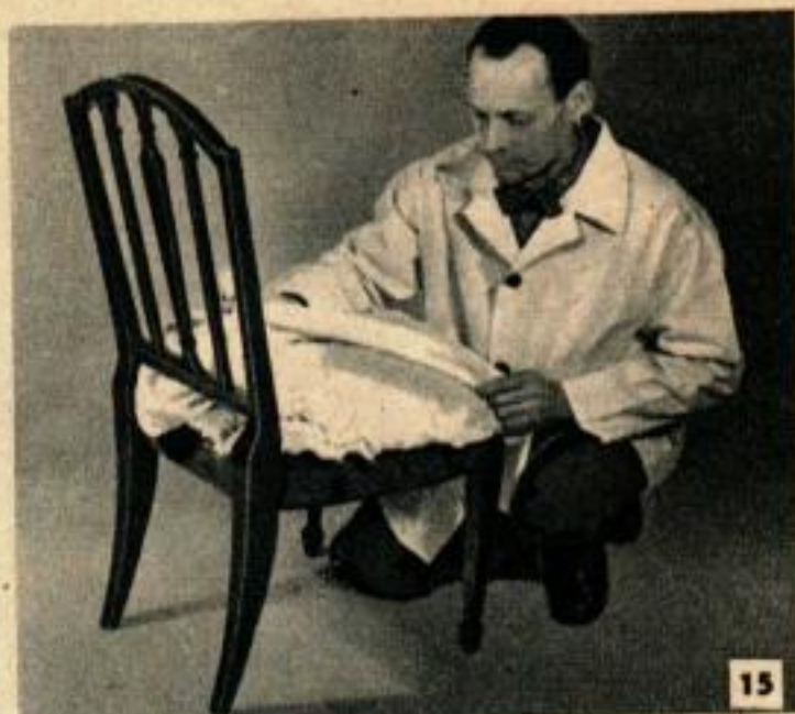
Le rembourrage consiste à mettre un coussin sur un siège en contreplaqué et à le recouvrir d'étoffe ou de tapisserie au choix de l'utilisateur.
