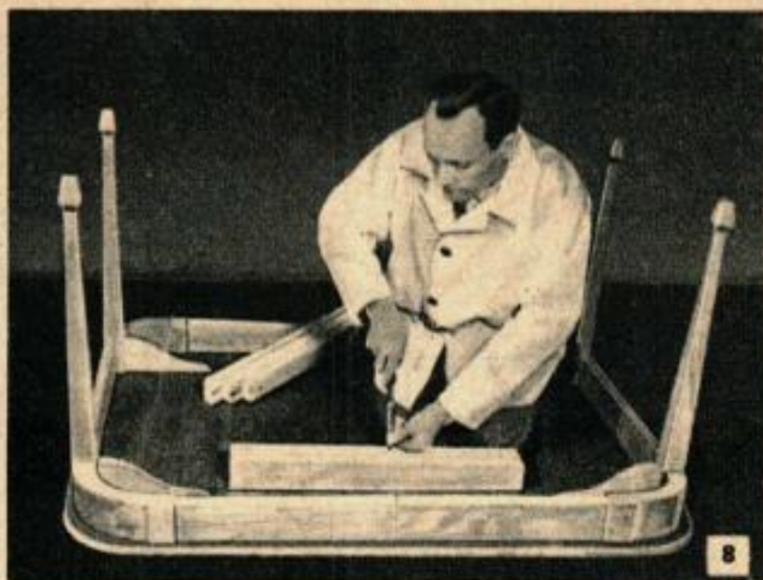
Mettre la ceinture sens dessus dessous sur un parquet bien droit et vérifier la position des pieds.
