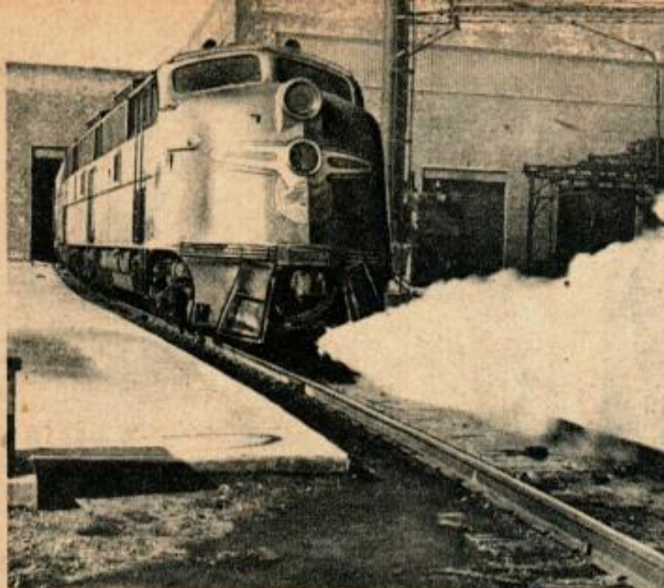
À gauche, une machine à moteur Diesel qui lance de la vapeur. Sa chaudière peut chauffer confortablement 100 maisons de 5 pièces. À droite, système de chauffage de la chaudière.
