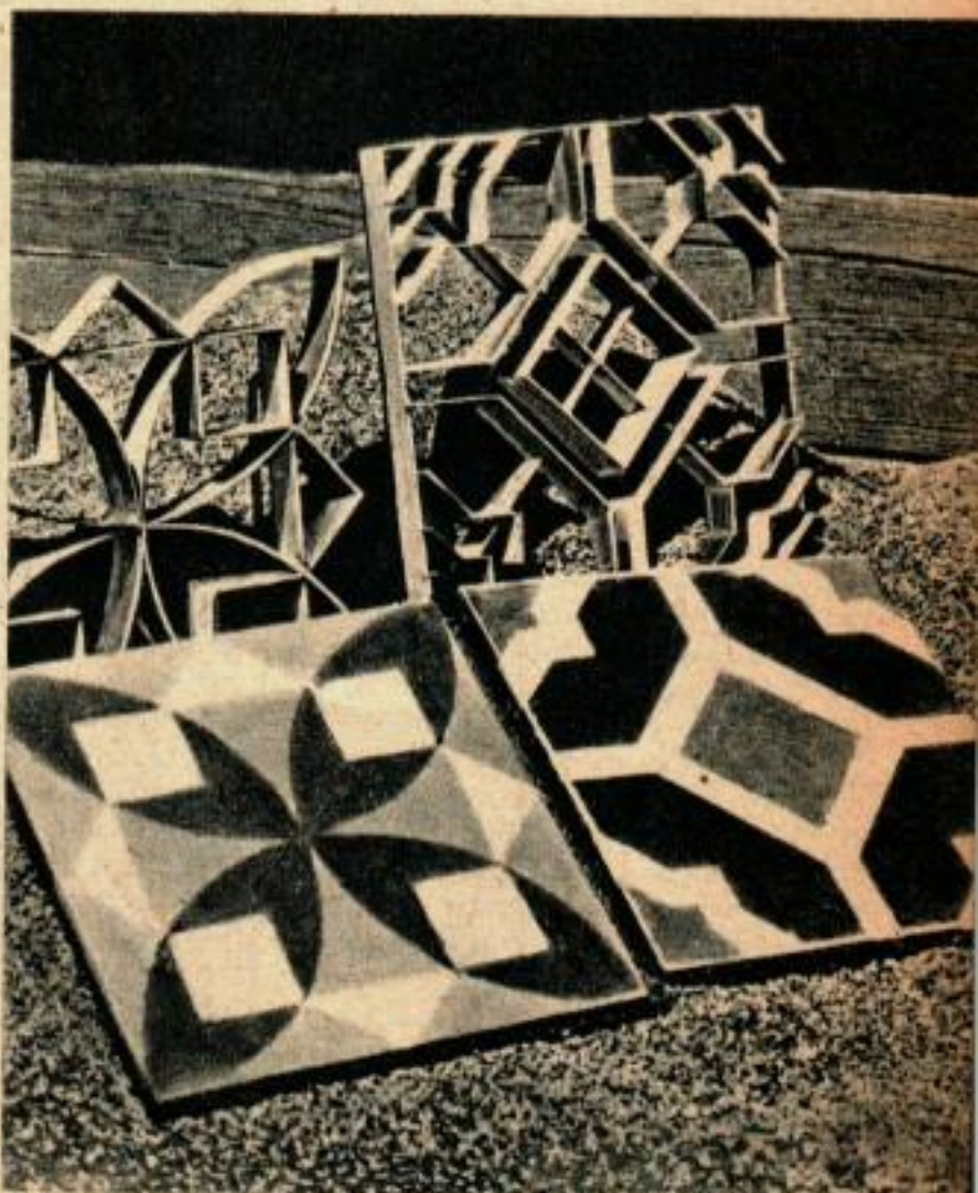
Les dessins sont obtenus au moyen de grillages en acier. L'exposition de la dalle aux intempéries n'affaiblit pas les couleurs.
