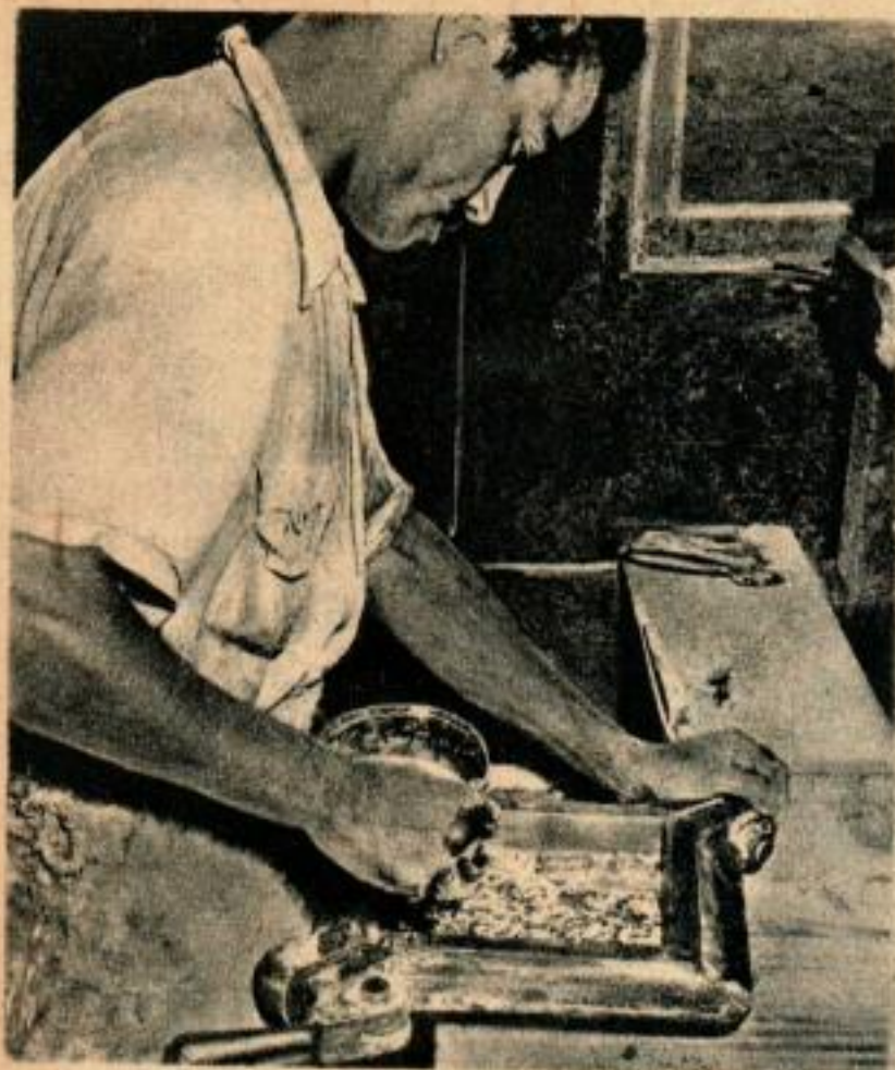
Après la 1 re couche qui comporte les dessins et les couleurs, on met la couche intermédiaire dans le moule.
