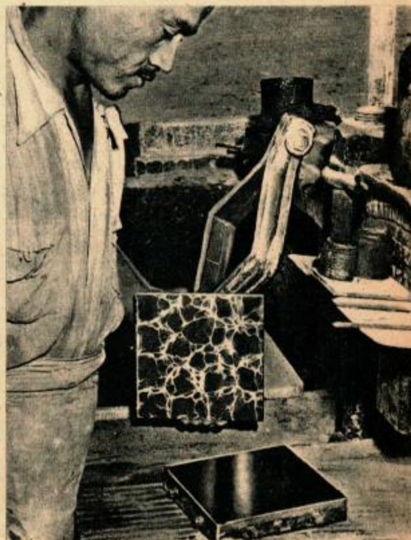
Les 3 dalles partielles sont maintenant unies. La dalle finie est enlevée du moule. On a ici un modèle marbré.
