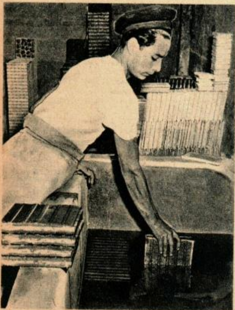
Après 12 heures de séchage à l'air libre, la dalle est mise dans un bain d'acide salicylique pendant 24 heures.
