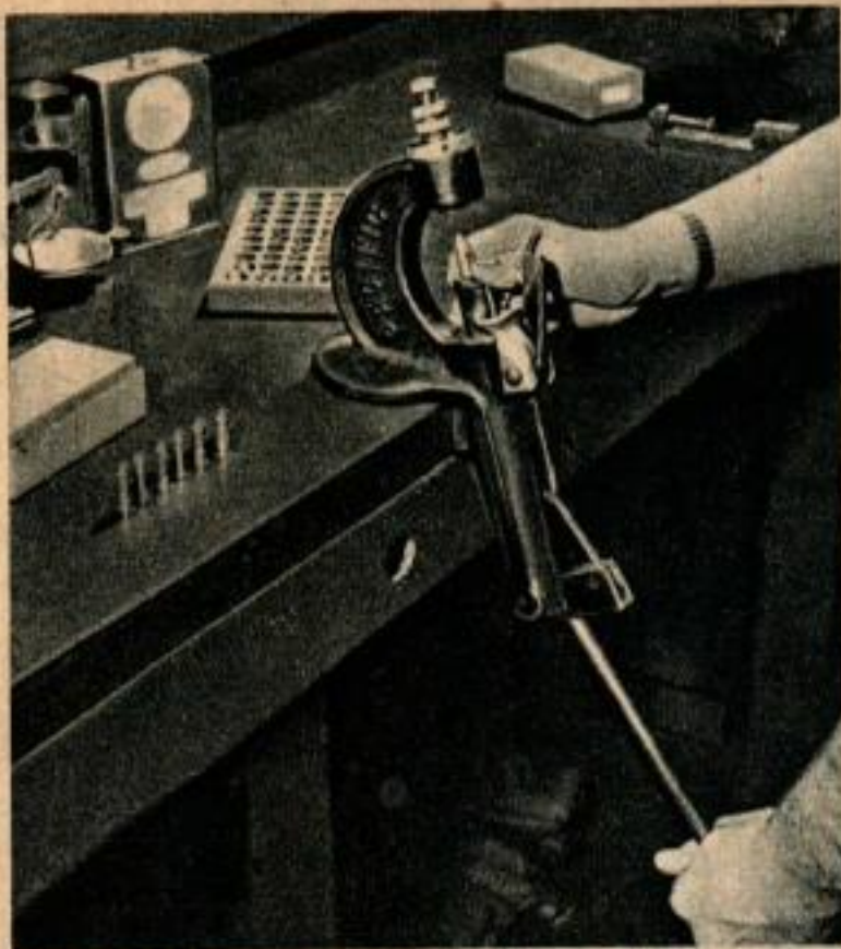
A gauche, installation permettant de reproduire les cartouches de tous les types imaginables afin de faire des essais. A droite, le tonneau à secousses qui permet d'essayer les grenades faussement accusées d'avoir provoqué l'explosion d'un wagon.
