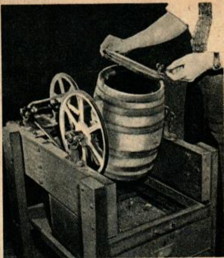
A gauche, installation permettant de reproduire les cartouches de tous les types imaginables afin de faire des essais. A droite, le tonneau à secousses qui permet d'essayer les grenades faussement accusées d'avoir provoqué l'explosion d'un wagon.
