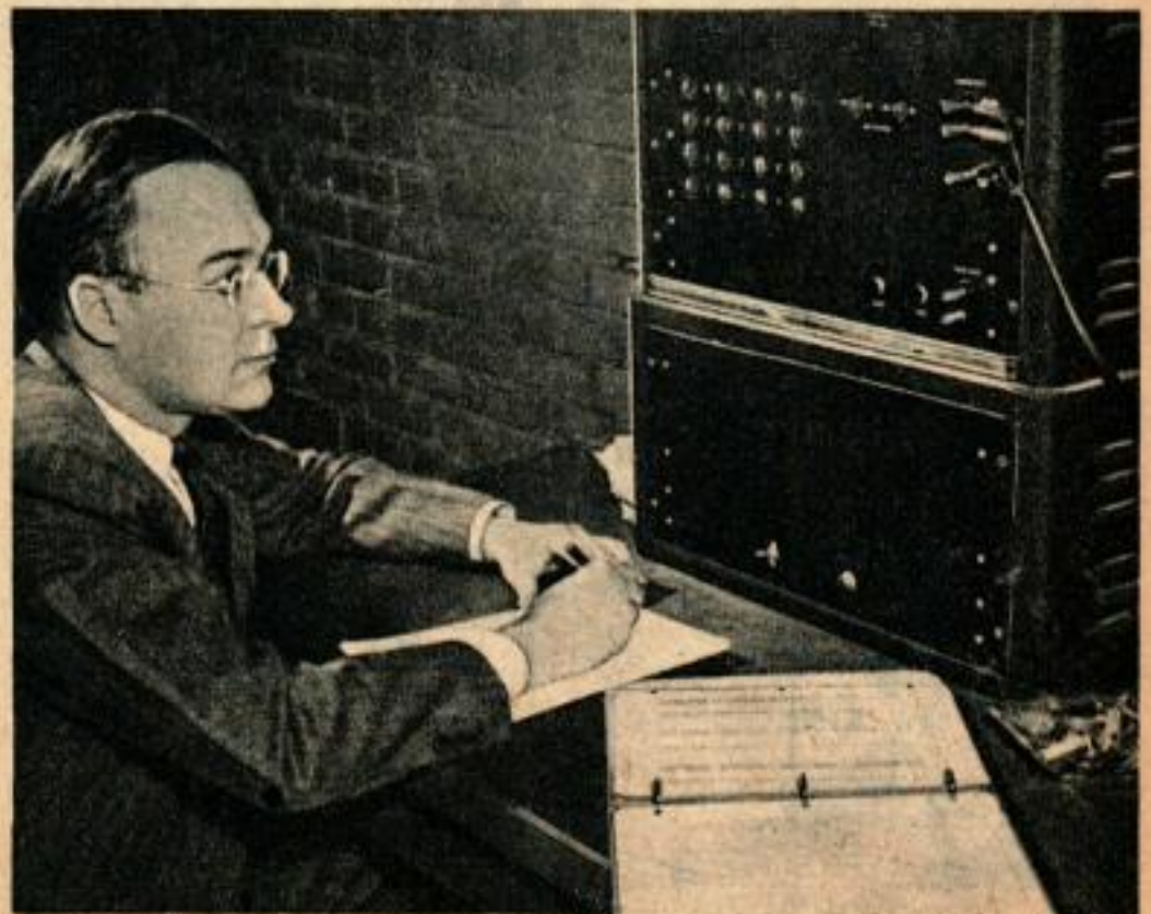
White, le fondateur du laboratoire surveille le tableau du chronographe afin d'en déduire la vitesse des balles par la mesure du temps mis pour franchir les 3 m qui séparent les 2 cadres.
