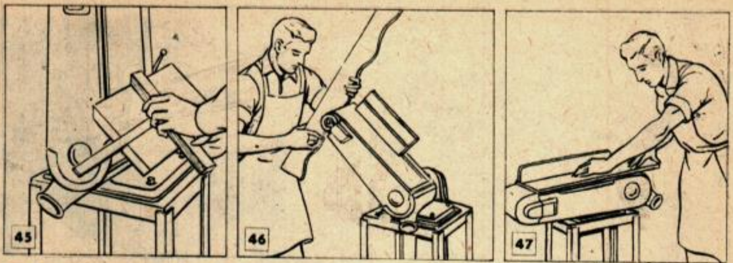
Les ponceuses telles qu'on en voit un exemplaire dans les dessins ci-dessus, sont des machines offrant beaucoup de ressources dans leur emploi et on les utilise souvent dans les ateliers petits et moyens. La machine comporte une table inclinable, amovible, qu'on retire pour poncer les grandes longueurs.
