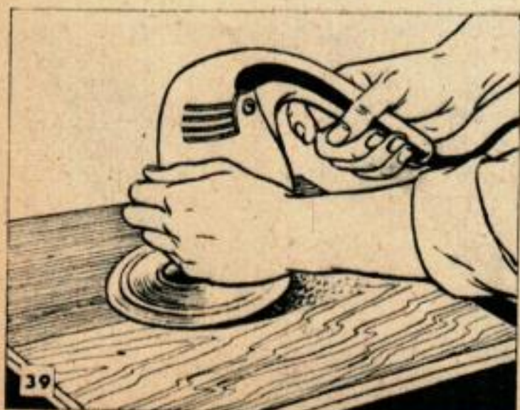
Ci-dessus, utilisation d'une machine à table inclinable pour pièces en blais et onglets. Ci-dessous, les ponceuses portatives sont très utiles pour les travaux préliminaires sur bois et sur métaux.
