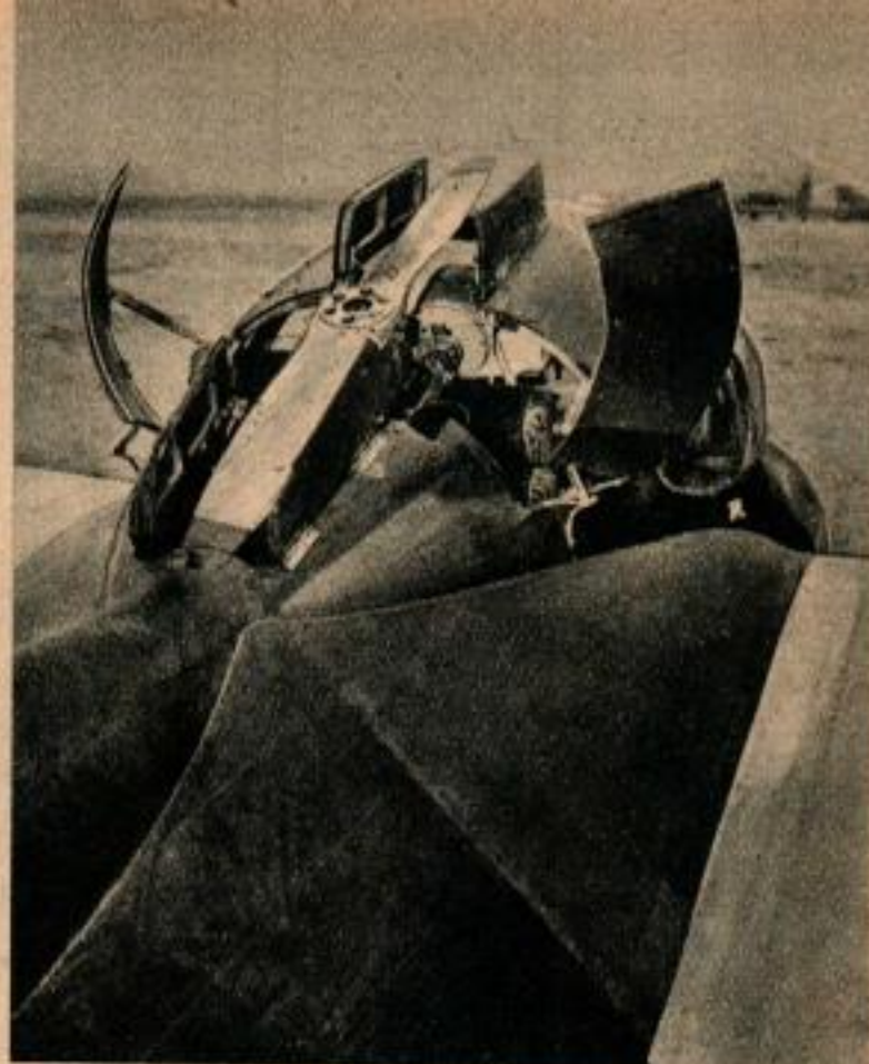
Le moteur se commande entièrement à partir du poste de pilotage. À gauche, il est en position de décollage, ci-dessus, il est rabattu et recouvert d'un capotage profilé lorsqu'on n'en a pas besoin.
