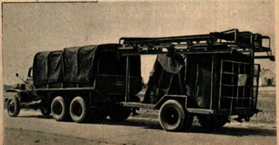
Ci-dessus, les plateaux chargés de pains cuits sont posés sur des convoyeurs qui les amènent aux magasins où ils restent pendant 2 heures pour refroidir. Ci-dessous, camion boulanger et remorque contenant le matériel de malaxage et de moulage des pains.
