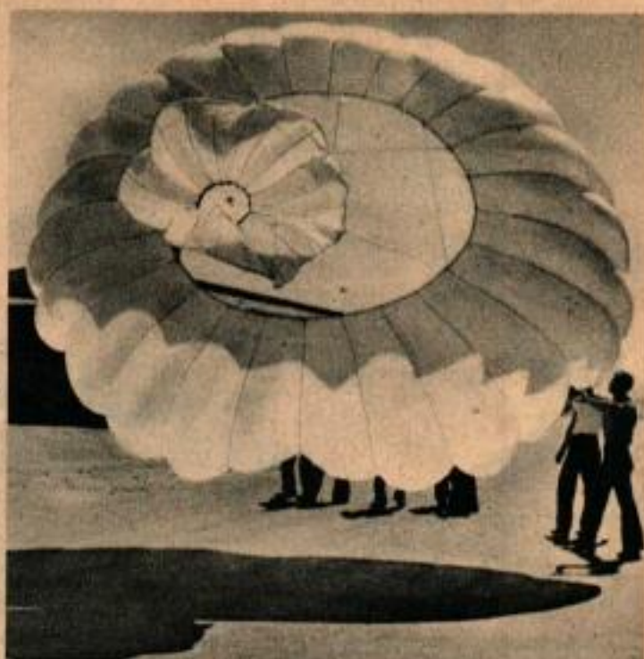
Le parachute Apex a une ouverture au centre avec, au-dessus, un dôme plus petit maintenu en position correcte par des haubans.
