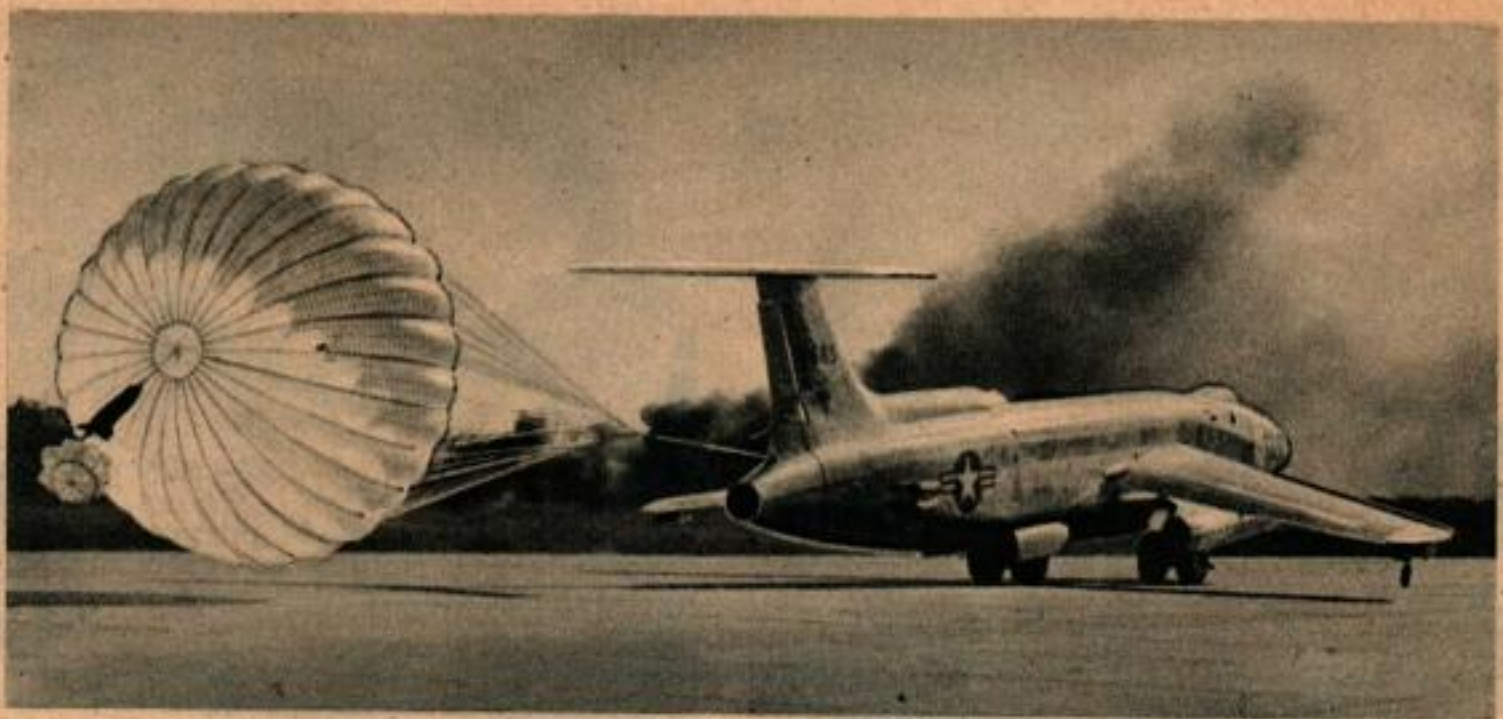
Le parachute en ruban sert de frein supplémentaire pour diminuer la longueur de l'atterrissage d'un nouveau bombardier à réaction à grande vitesse.
