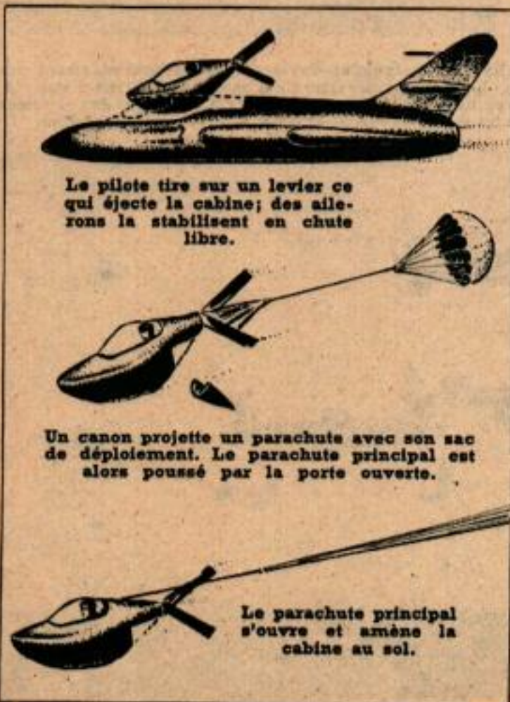
Le dernier des dispositifs de sauvetage pour le pilote est ce parachute pour cabine qui est projetée hors de l'avion quand le pilote tire sur un levier; la cabine est sous pression et isolée. Le parachute amène la cabine à terre.
