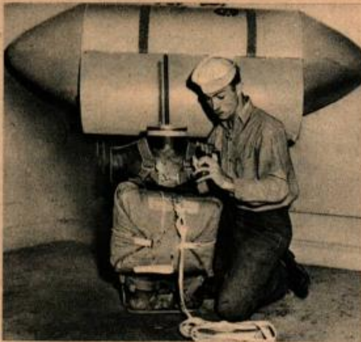
Le parachute est attaché au parachutiste robot pour un saut d'essai. L'antenne, recouverte de caoutchouc, dépasse le cou du robot.
