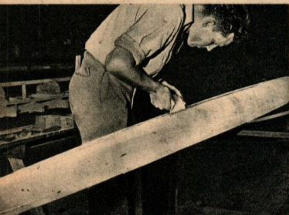
Ci-dessus fixation au fond du bateau de la petite quille métallique en forme de croix. Ci-dessous les sièges de ces bateaux de course reposent sur des rouleaux qui glissent sur un rail permettant aux rameurs d'allonger leurs coups d'aviron.
