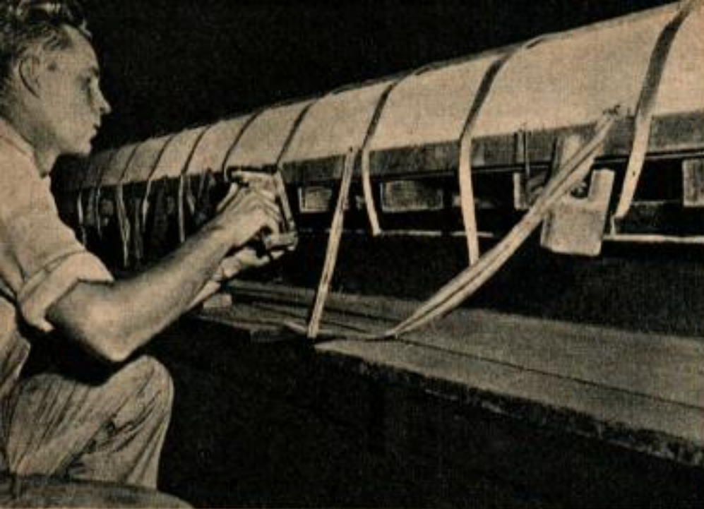
Ci-dessus fixation du contreplaqué de 1,5 mm formant la coque d'un bateau à un rameur. La forme finale lui sera donnée à la vapeur.
