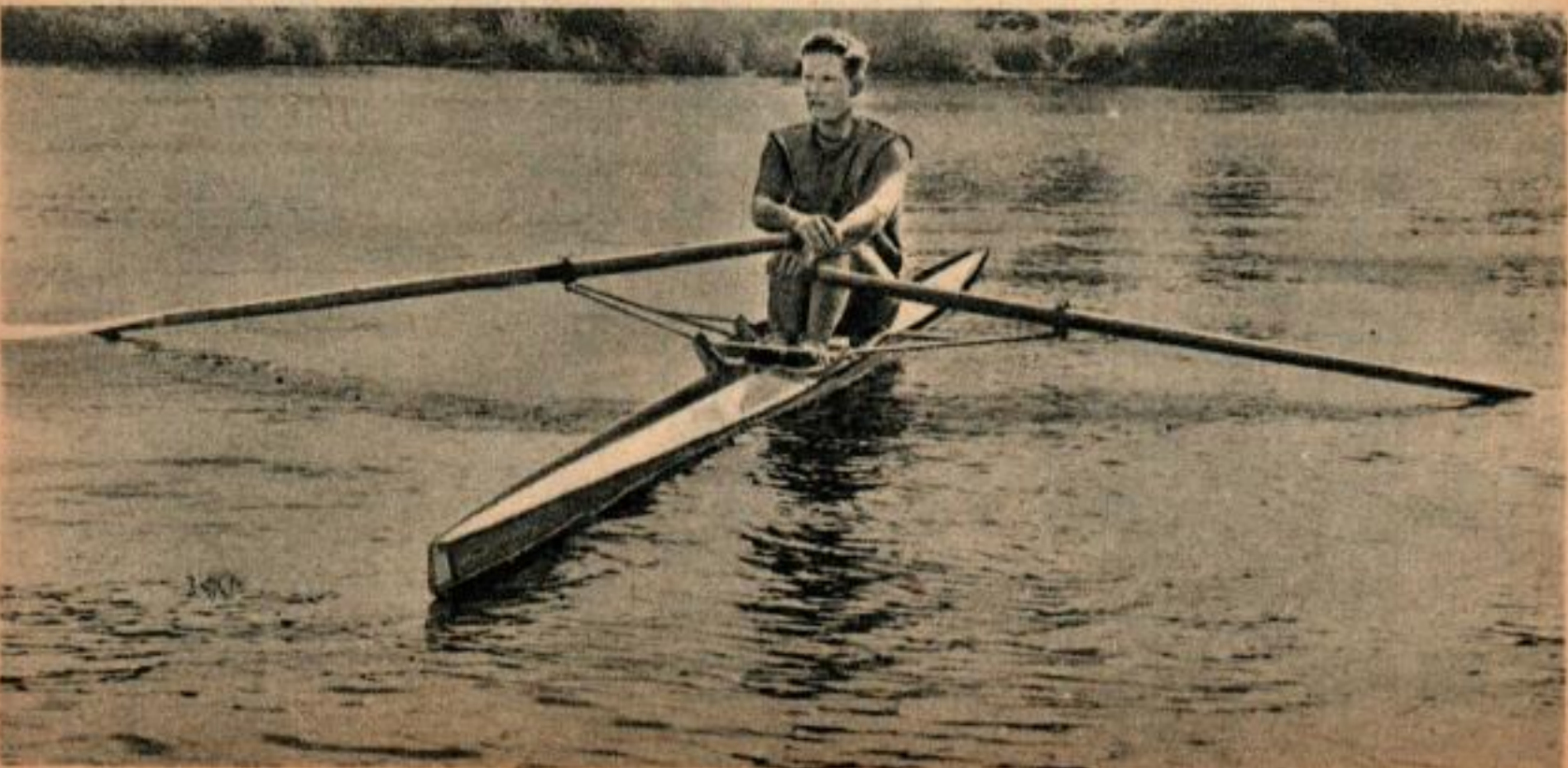
Dans l'eau, la coque d'un bateau de 15 kg a environ 10 cm de tirant d'eau et 5 cm de franc-bord.
