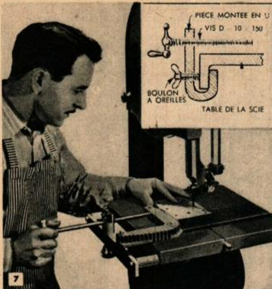
7 Une avance à vis économise les efforts lorsqu'il s'agit de scier une pièce épaisse.
