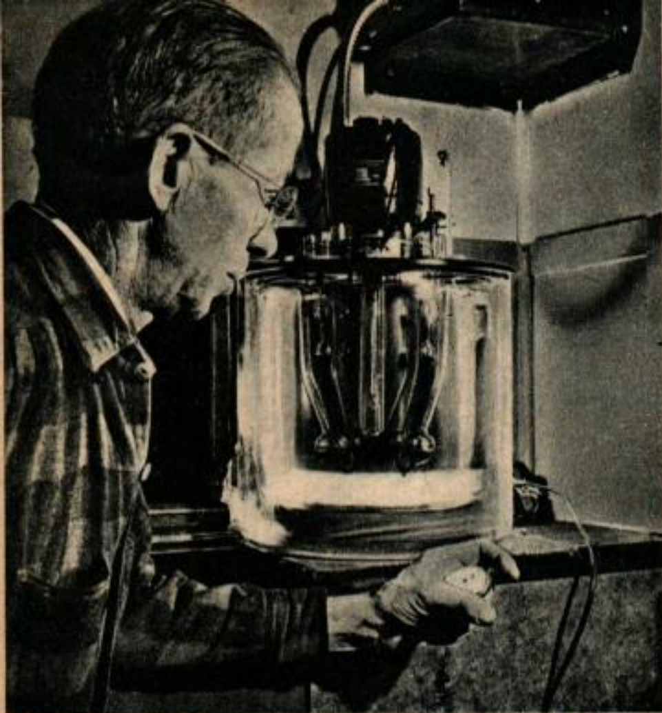
L'huile est continuellement vérifiée durant le reraffinage afin qu'on soit sûr de ses qualités. Ici, on mesure sa viscosité.
