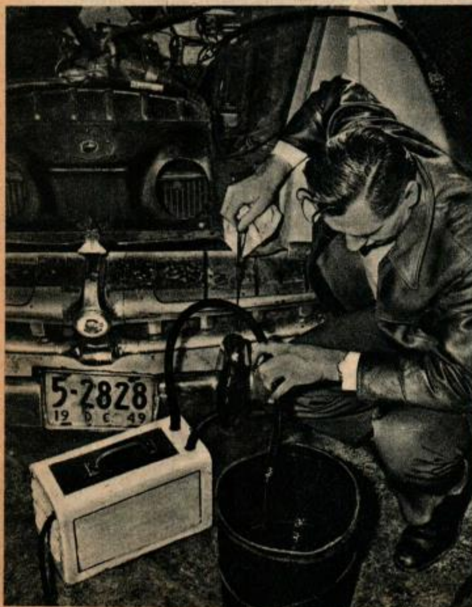
Ci-dessous, on assiste à la vidange de l'huile usée. Cette opération se fait à chaud en utilisant une pompe de carter.
