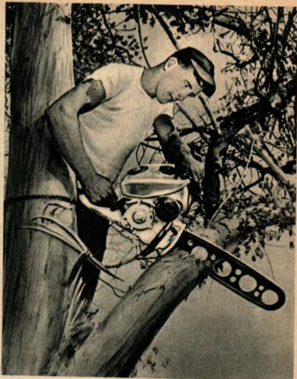
Cette scie ne pèse que 11,5 kg et elle opère très rapidement. Ci-dessous, à gauche, la mise en marche se fait en tirant sur le câble de démarrage. À droite, débitage d'un tronc en morceaux de petite longueur au moyen de la scie à chaîne.
