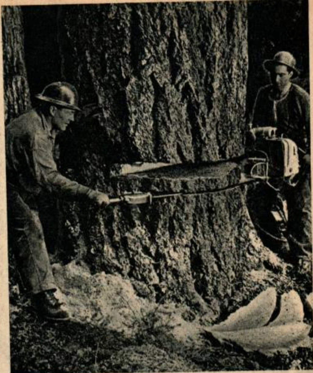
Les plus gros arbres n'arrêteront ni les hommes ni la scie. On voit ici 2 bûcherons qui font une entaille préliminaire à la base de l'arbre. Celui de gauche a pour fonction d'appuyer la scie sur le tronc.
