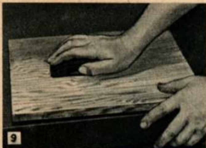
9 La passe de finition se fait avec un papier très fin que l'on déplace parallèlement au fil du bois. Bien maintenir une pression constante tout le long de la course du bloc abrasif.
