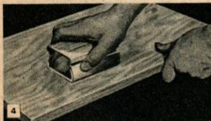
Ci-dessus, sauf sur les bois à pores très ouverts, le ponçage final est fait dans la direction du fil. Ci-dessous, on ponce à angle droit du fil afin d'aplanir les irrégularités.
