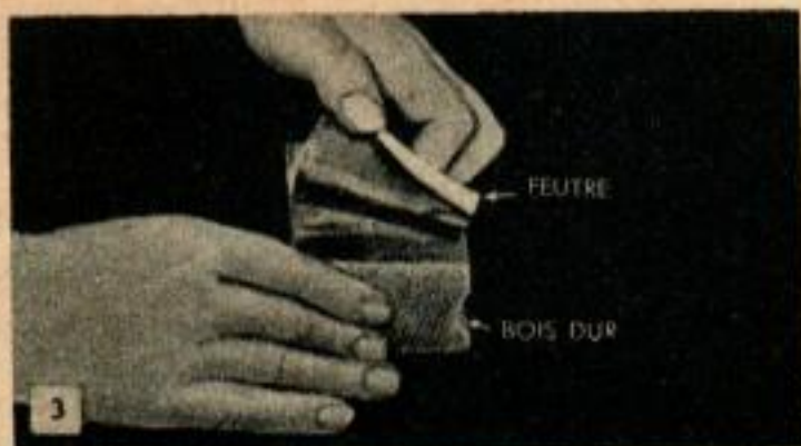
Un bloc de bois dur doublé de feutre constitue un outil très commode. Le feutre est collé sur le bois et a une épaisseur de 3 à 10 mm.
