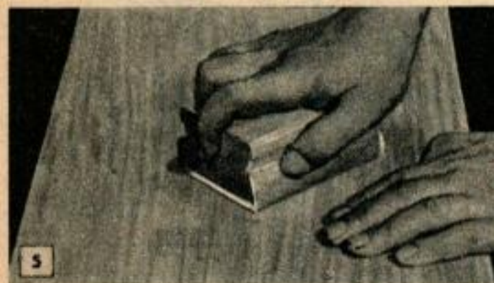
Ci-dessus, sauf sur les bois à pores très ouverts, le ponçage final est fait dans la direction du fil. Ci-dessous, on ponce à angle droit du fil afin d'aplanir les irrégularités.
