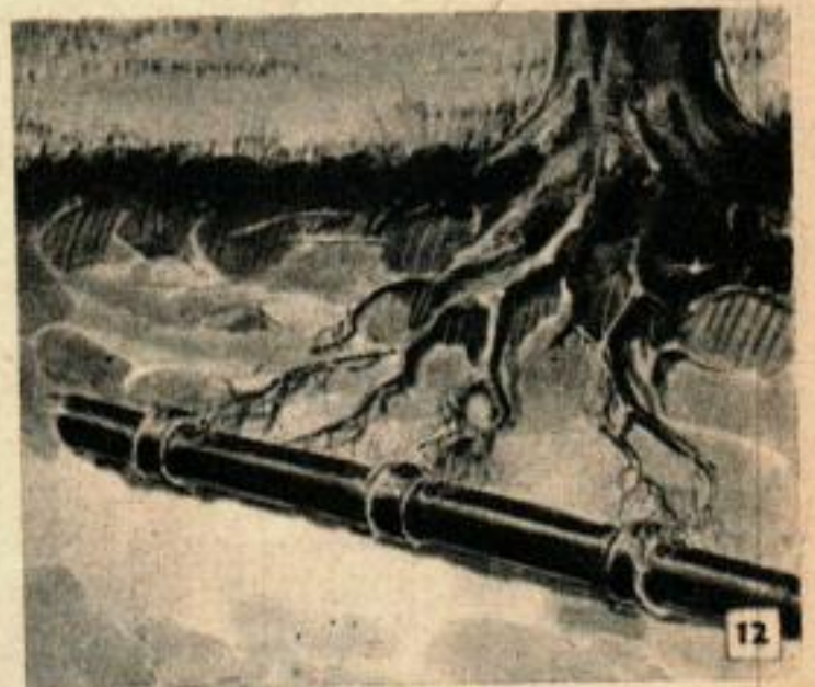
Les racines qui attaquent les tuyaux proviennent parfois d'arbres situés à 6 m de là.
