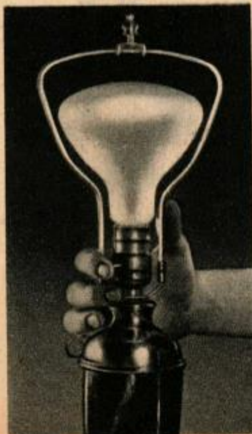
5. Remettre le fil, remonter la douille, mettre la nouvelle ampoule en place.
