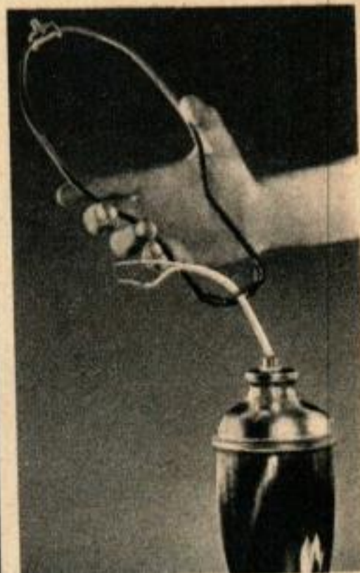
4. Dévisser la partie inférieure de la douille et enlever l'ancienne lyre.
