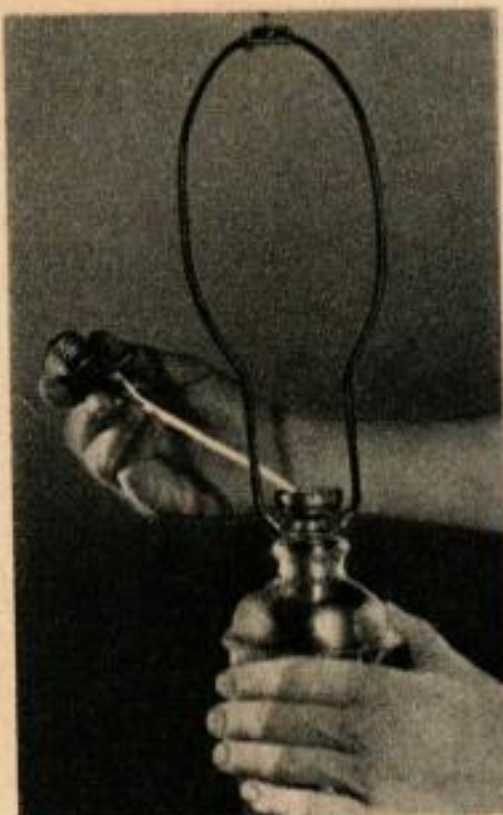
2. Enlever la partie amovible de la douille et sortir 15 cm de fil.
