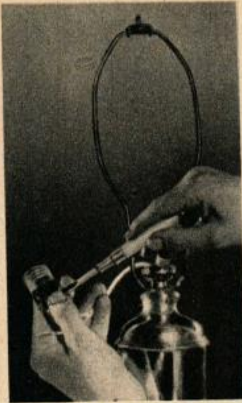
3. Au moyen d'un tourne-vis, desserrer les vis et enlever le fil.
