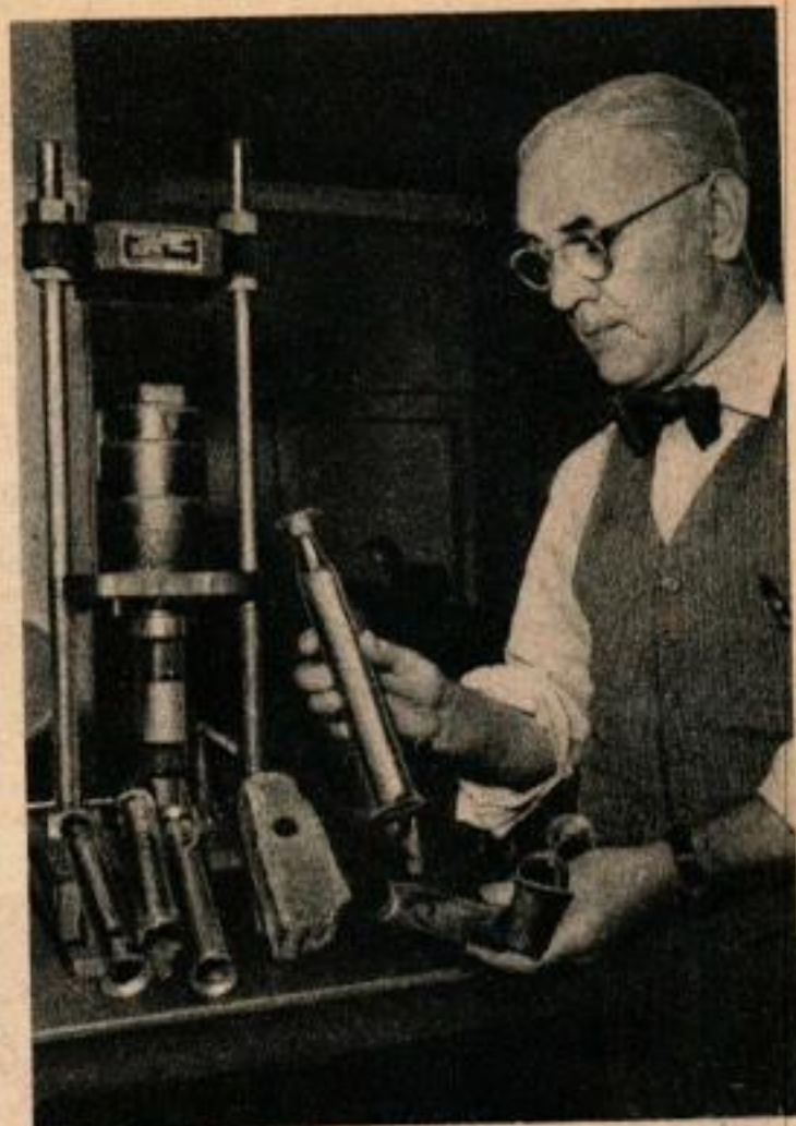
Le fabricant de fusées, John Ashworth, tient dans ses mains des échantillons de coquilles d'acier avant les essais.
