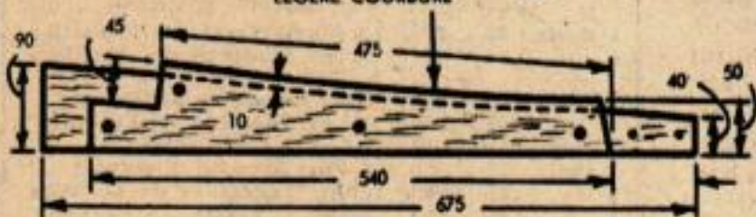
7 ASSEMBLAGE DE 2 SECTIONS DE VOIE LÉGÈRE COURBURE
