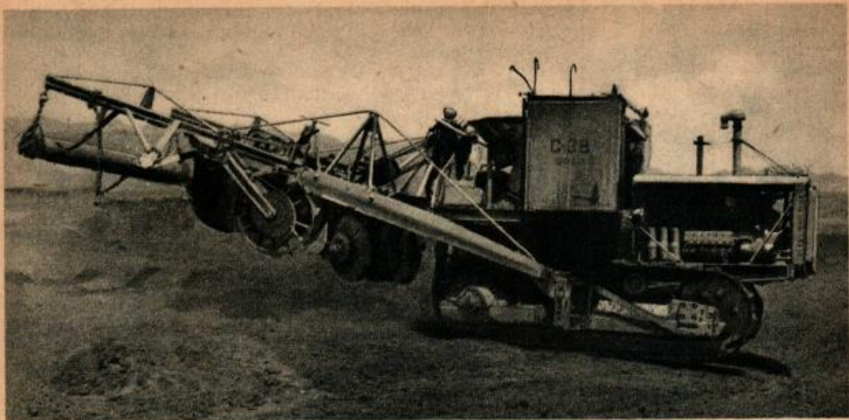
Sur cette fouilleuse les disques brisent le sol jusqu'à 50 cm de profondeur. Le rouleau à l'extrémité du bras aplanit la terre.
