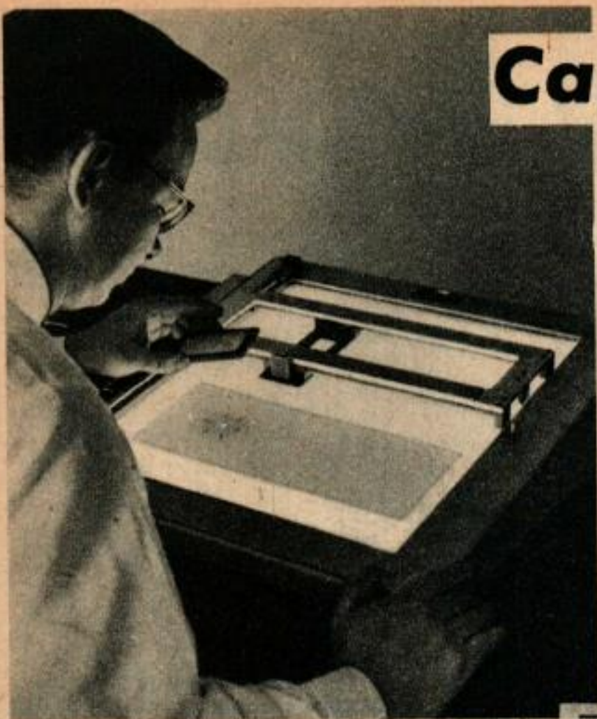
Ci-dessus un chercheur de la General Electric étudie un film photographique impressionné par des rayons X diffractés par la structure interne du cristal de décaborane. Pendant l'exposition le film était enroulé sur un cylindre. Ci-dessous, le Dr. John Kasper tient un modèle de cristal de décaborane.
