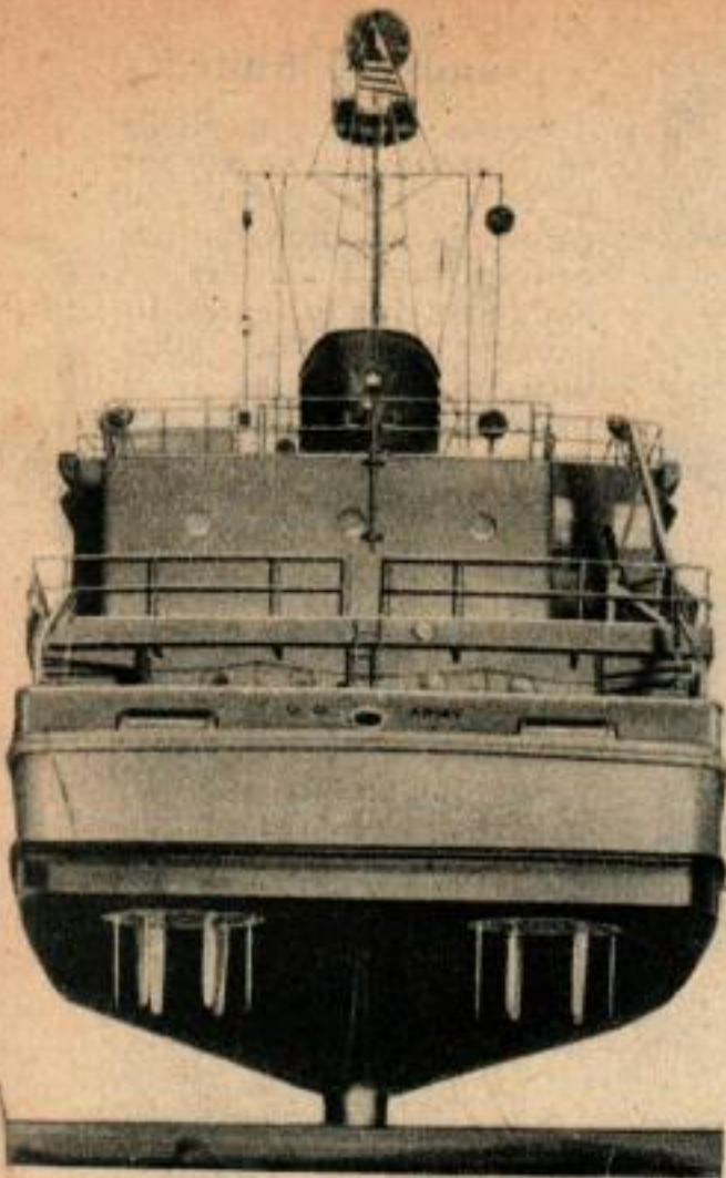
Sur ce mouilleur de mines en modèle réduit 12 lames plongent à partir de 2 disques. Ci-dessous un propulseur cycloldal installé également sur un remorqueur. Celui-ci n'a que 8 lames, le nombre de celles-ci n'étant pas constant.
