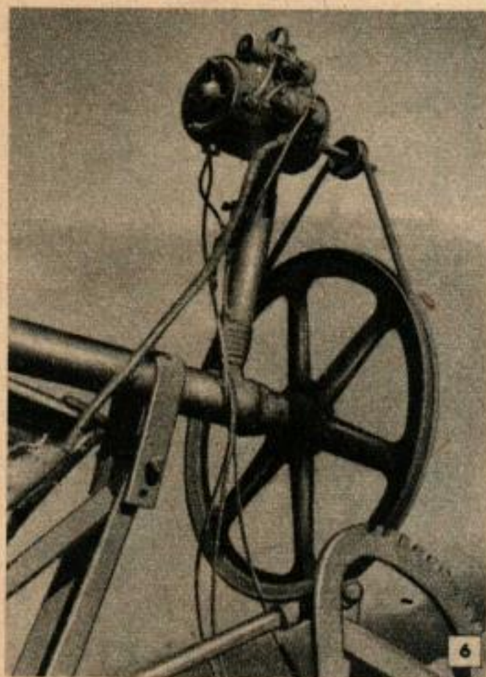
Ci-dessous, une excellente vue de la poulie et du moteur. La dimension de la poulie détermine la vitesse de la commande de la barre porte-couteaux.
