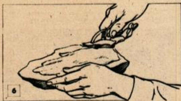
6 Briser le moule qui désormais ne servira plus.
