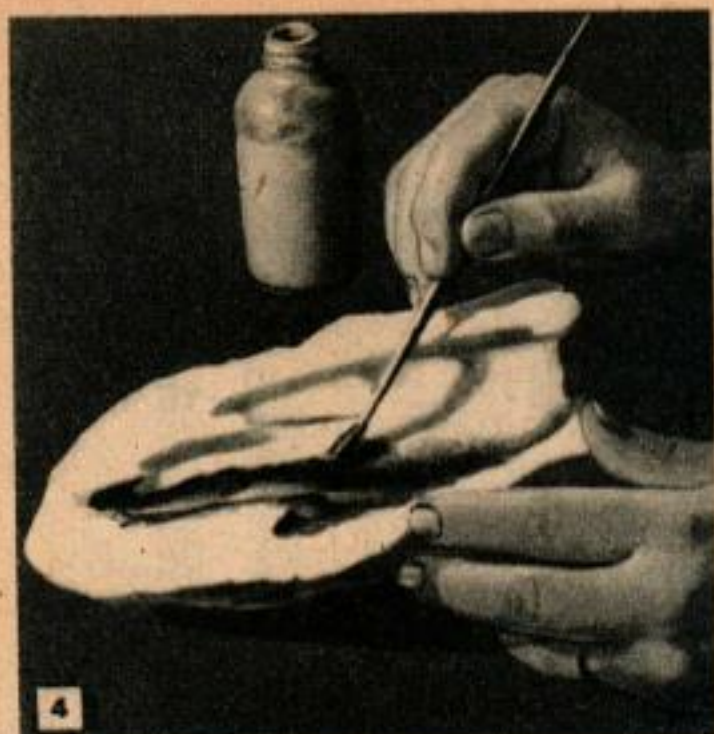
4 La cavité du moule est recouverte de deux couches de vernis.
