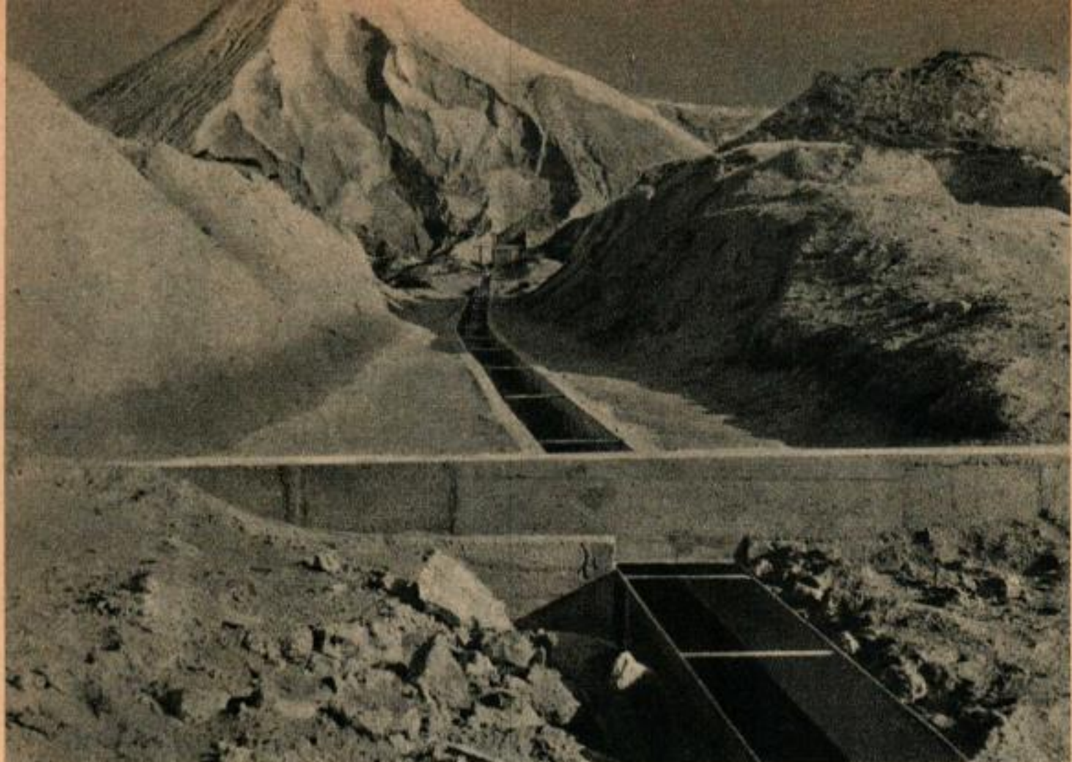
Le matériau tiré des tas de résidus de kaolin à l'arrière-plan est emmené par le canal en premier plan jusqu'à l'usine pour y être traité et moulé.
