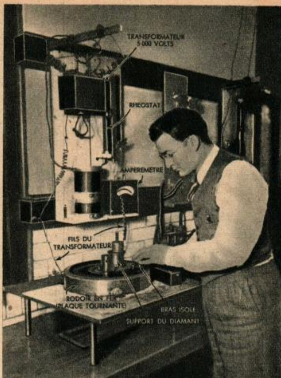
La nouvelle technique accélère la taille des diamants. Un courant haute-tension envoyé sur le diamant le rend moins dur pendant la taille. Cidessous la roue tournante donne un poli très grand à chacune des 56 facettes en un tour.
