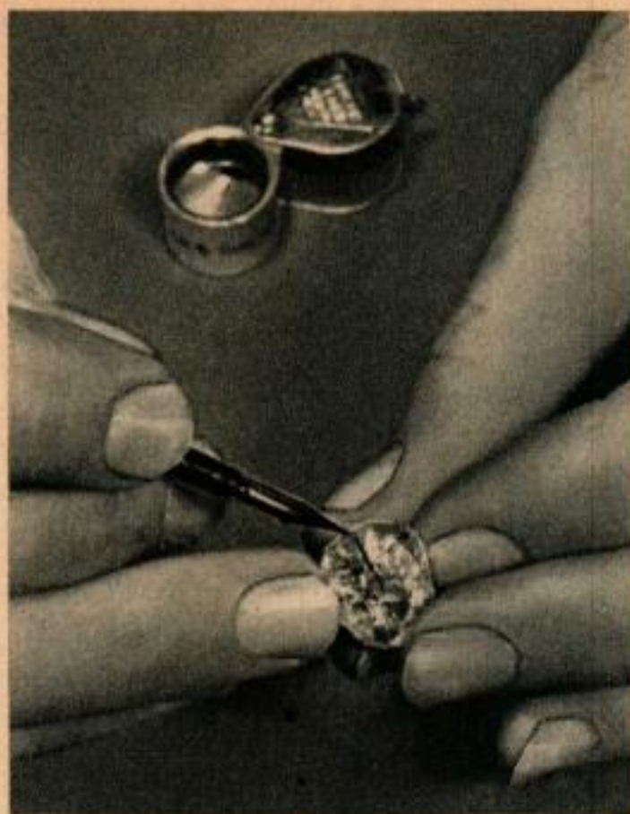
Après une longue étude, un diamant de valeur est marqué à l'encre de Chine pour le sciage. Une erreur de jugement pourrait détruire toute la pierre. A droite la gemme fixée dans un support passe sur la lame de scie qui la taille.
