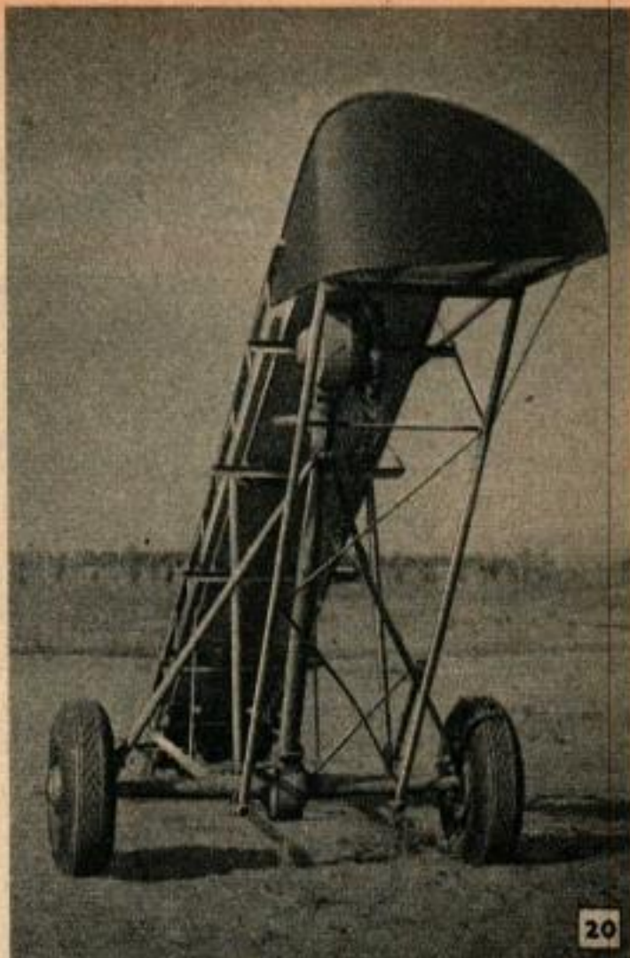
Ci-dessus, vue arrière montrant la paroi courbe de la plate-forme supérieure servant à retourner la balle pour sa réception par l'opérateur. Ci-dessous, le différentiel et l'embrayage à l'extrémité de l'arbre incliné.
