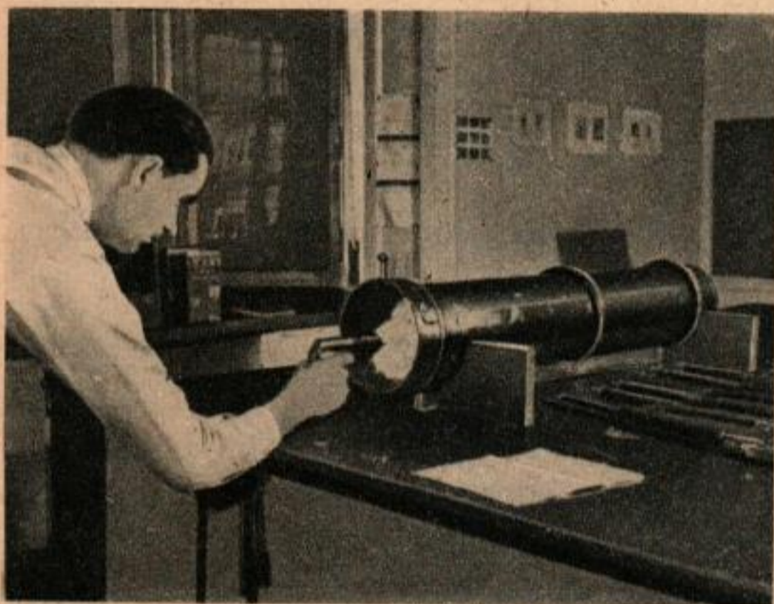
L'expert en munitions tire une balle dans un tube rempli de vieux papiers, ce qui fait que la balle ne porte aucune autre empreinte que celles laissées par les rayures de l'arme. Ci-dessous, on en voit un autre qui examine avec un système optique convenable l'intérieur d'un canon de revolver.
