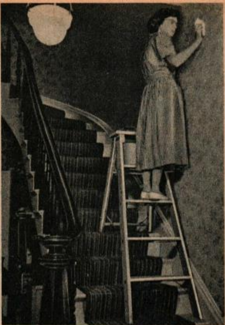
Escabeau d'escalier. — La partie arrière est réglable, ce qui permet de l'utiliser sur des surfaces qui ne sont pas au même niveau. Les parties coulissantes des pieds sont en aluminium épais.
