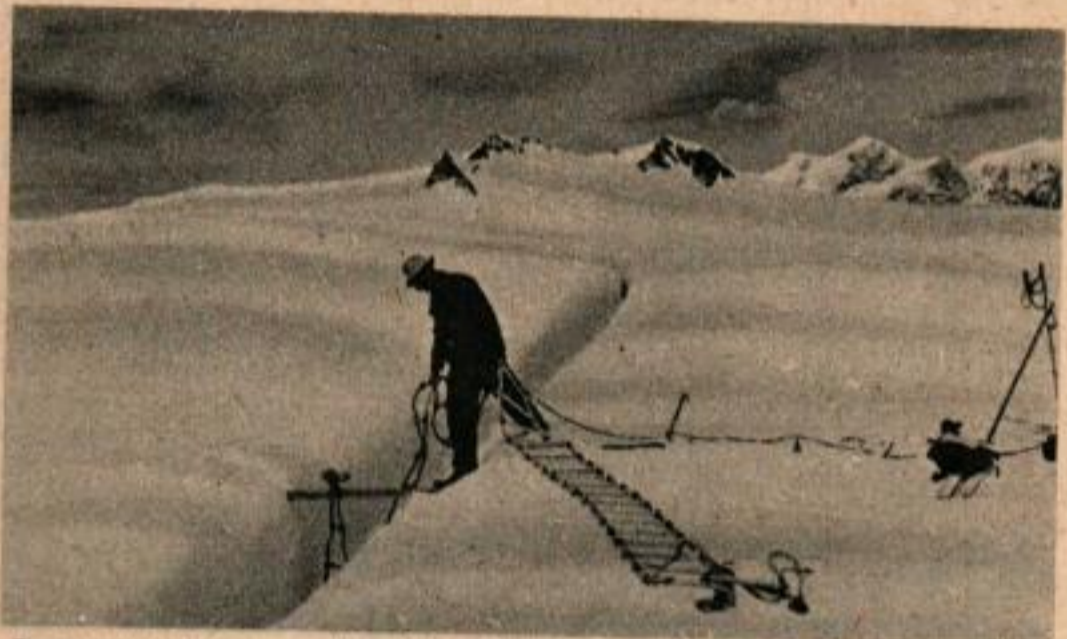
Le savant enfonce un piquet dans la neige en travers de la crevasse et descend une échelle de corde. Il étudiera ainsi les couches annuelles de croissance du glacier.
